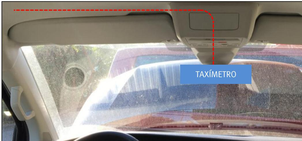
**Figura 43.** Trazado del cable del módulo tarifario **Madrid**.
