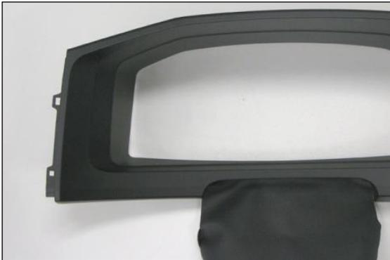
Figura 20. Cubierta cuadro de instrumentos.
