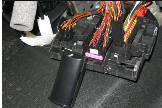
**Figura 3.** Extracción de la caja de fusibles.
