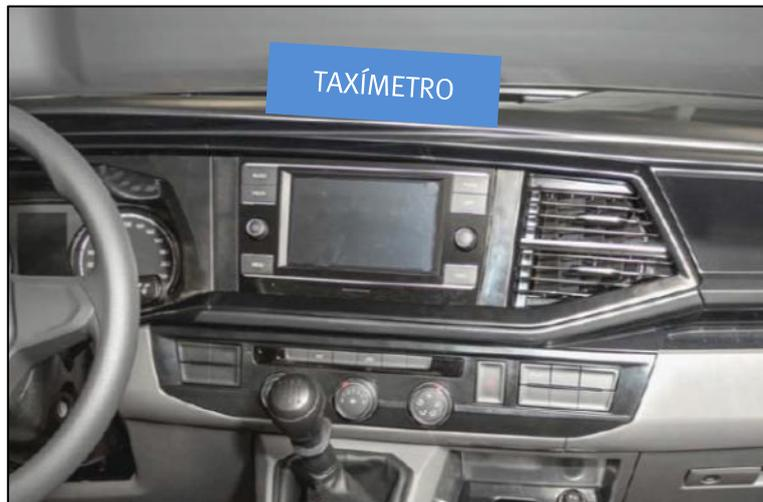
**Figura 37.** Área de instalación del taxímetro.
