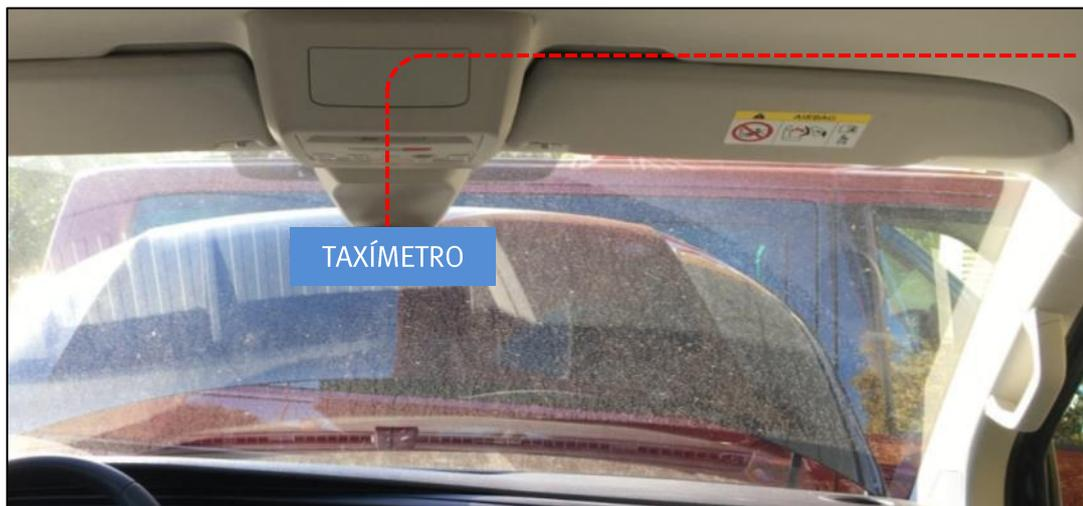
Figura 42. Trazado del cable del módulo tarifario **Barcelona**.
