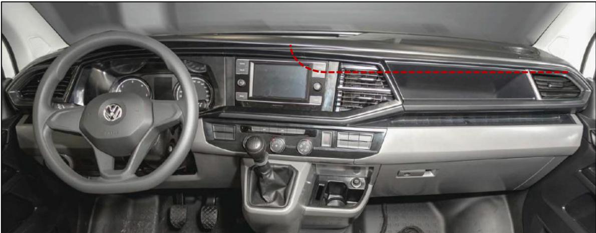
Figura 28. Trazado de la manguera para **Barcelona**.
