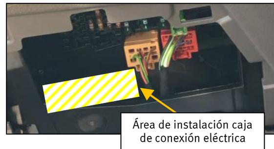
Figura 6. Área de instalación caja conexión eléctrica.
