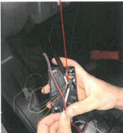
Conexiones caja adaptadora de señal
