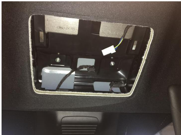
Desmontado el cuadro, se nos muestra el espacio para practicar los taladros para la fijación del módulo tarifario y el paso de los cables de alimentación y señales provenientes del taxímetro.
