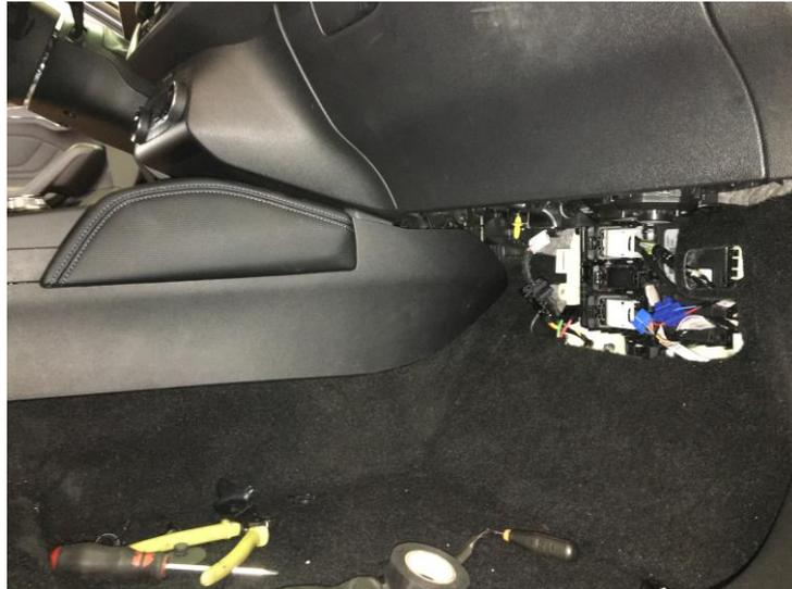
Desmontamos el guarnecido lateral fácilmente al ir sujeto mediante grapas.
