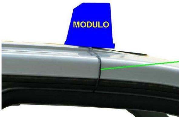
Paso del cable del módulo repetidor de tarifas múltiples por debajo de la goma de estanqueidad de la puerta
