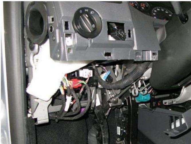
Se desatornillan por la parte inferior los tornillos de fijación del cuadro de instrumentos.
