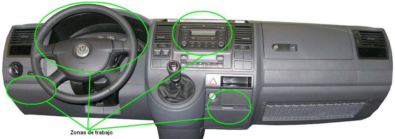
Se retira la cubierta del difusor del aire lateral izquierda, mediante una cuña de desmontaje, y se desatornilla el tornillo de fijación de la cubierta embellecedora.
