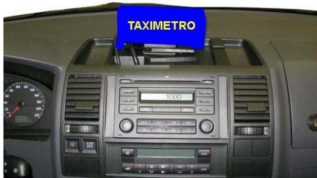
Se pasa la manguera del dispositivo impresor por debajo del salpicadero (lado conductor) y se monta el dispositivo impresor encima del salpicadero al lado del montante A izquierdo.
