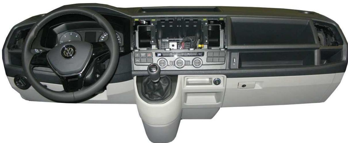
**A2)** Desmontar el alimentador 12 v. en la parte superior central del tablero para utilizar el hueco como paso de las mangueras.
