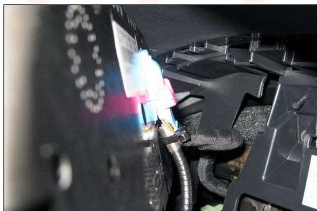
7) Pasar la manguera blindada de la señal taquimétrica, procedente del pin nº 9 del cuadro de instrumentos, por detrás del alojamiento del cuadro, hacia el hueco inferior de la radio.
