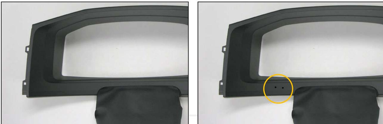
Detalle agujeros cubierta de la columna de dirección
