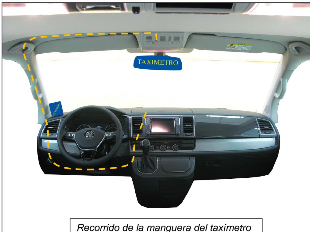
**B3)** Pasar la manguera del módulo tarifario desde la conexión del taxímetro hacia el asidero derecho pasando por debajo del revestimiento techo.
