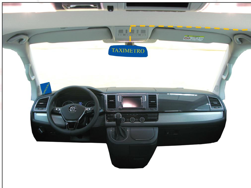
**B4)** Montar el módulo tarifario. Se deberá garantizar que el módulo quede perfectamente adaptado al perfil del techo.
