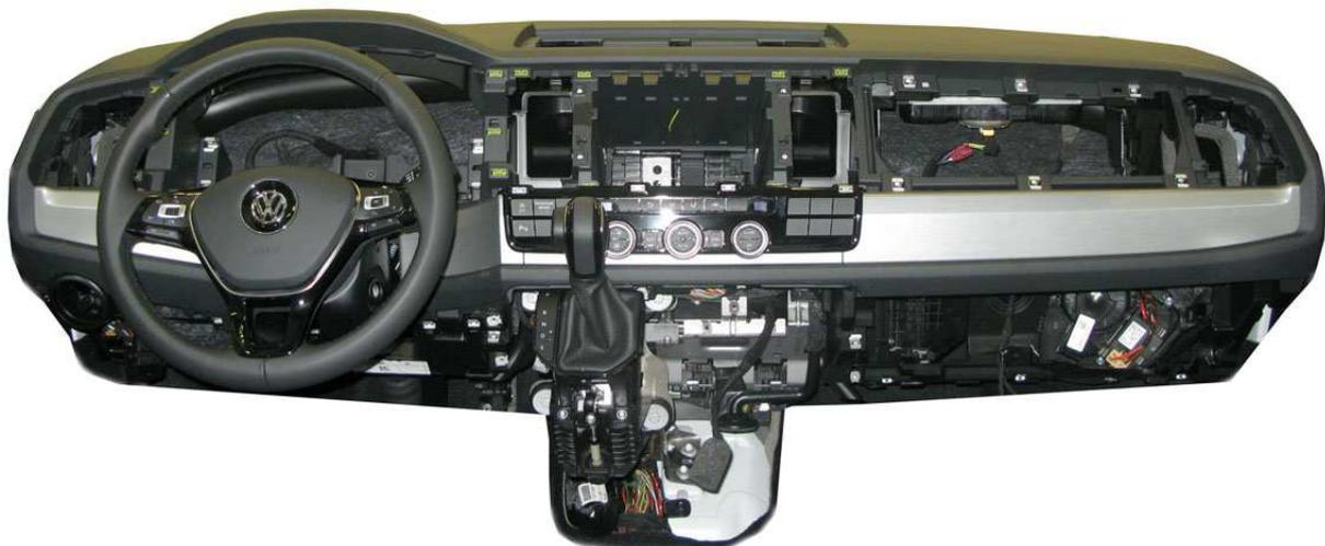
A2) Efectuar los taladros necesarios para el paso de las mangueras en las zonas marcadas de la guantera superior central del tablero.
