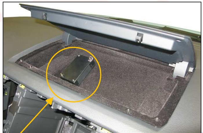
Cable de masa y caja de conexión eléctrica
