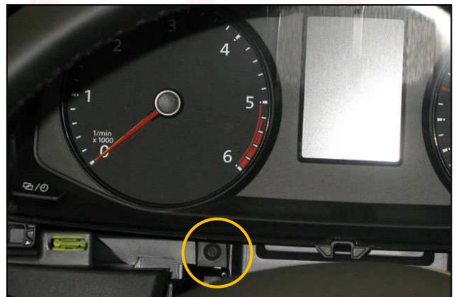
11) Practicar 2 agujeros de  $\varnothing$  1,5 mm. en la parte inferior izquierda del embellecedor del cuadro de instrumentos. Estos 2 agujeros tendrán una distancia entre sí de 10 mm.
