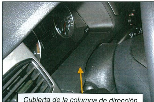
Cubierta de la columna de dirección
