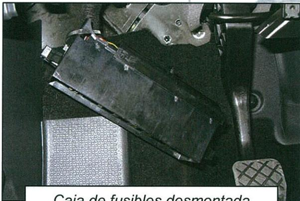
Caja de fusibles desmontada
