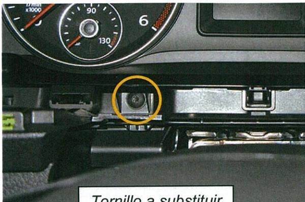
*Tornillo a substituir*
