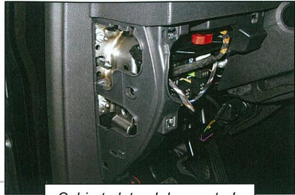
Cubierta lateral desmontada
