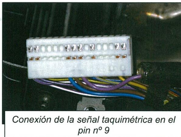
Conexión de la señal taquimétrica en el pin nº 9
