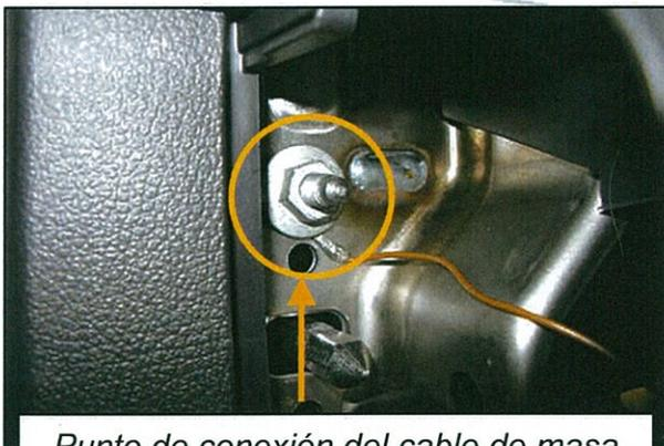
Punto de conexión del cable de masa
