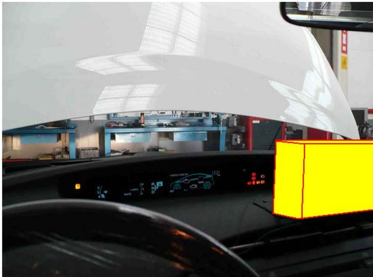
El dispositivo impresor, si procede, irá instalado al lado izquierdo del tablero. Su fijación será con velcro de alta resistencia, y el cable se llevará a través del guarnecido del lateral del pilar A izquierdo.
