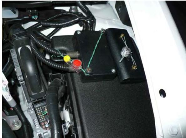
La alimentación eléctrica se tomará de la propia caja de fusibles, en un borne que hay en su interior, levantando la cubierta de plástico negra. En esta alimentación se montará un portafusibles aéreo con un fusible de protección. La conexión de masa se tomará con un tornillo a la chapa que hay en la parte inferior de la caja de fusibles.
