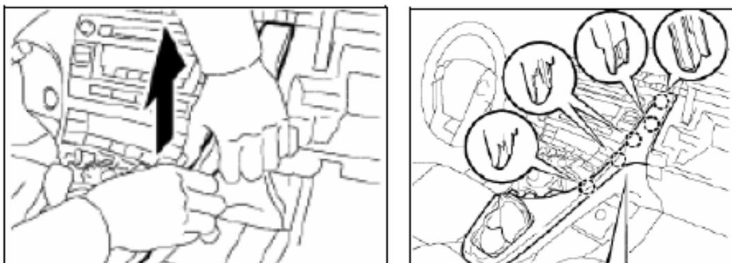
Posteriormente se desmonta el porta-vasos, mediante cuatro tornillos, del panel central de instrumentos.
