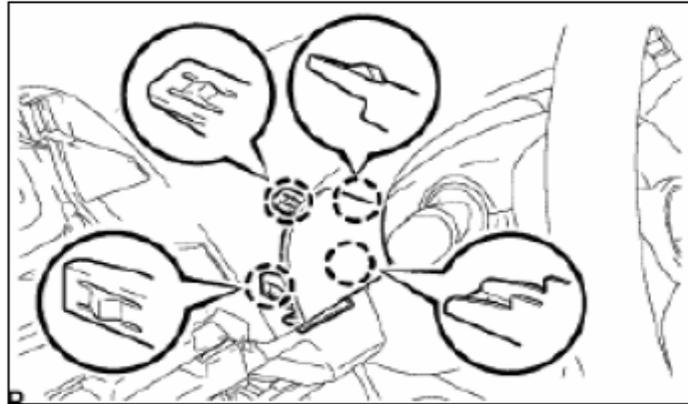
Se retira la goma del contorno de la puerta delantera izquierda en la zona del tablero, y se desmonta la cubierta lateral izquierda.
