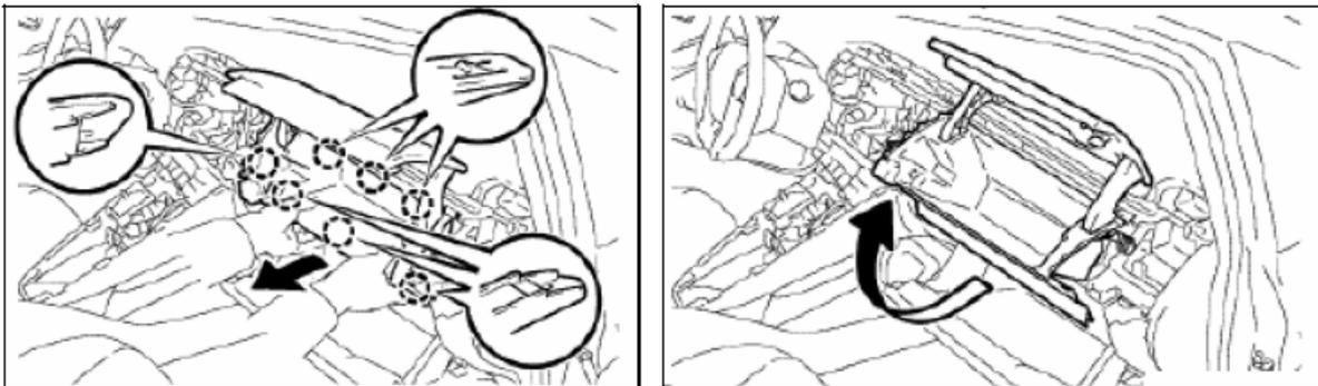
Se retira la goma del contorno de la puerta delantera derecha de la zona del tablero. Se desmonta la cubierta lateral derecha del tablero, tirando de la cubierta lateral del tablero (si procede, hay que desenchufar el conector del airbag antes de retirar la cubierta).
