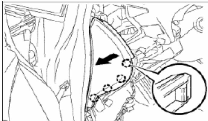
Se desmonta el canalizador del aire superior derecho, mediante un desmontador de molduras y retirando las tres grapas de sujeción.
