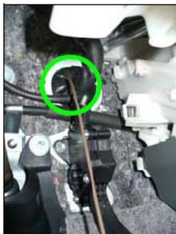
La caja de señales donde irá conectada la manguera blindada que viene del cuadro de instrumentos irá instalada encima de la cubierta de la caja de fusibles del motor, fijada mediante tornillos y precintada.
