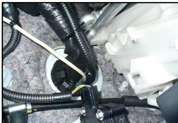
Passar cables por el pasamuros, sobre el pedal del acelerador
