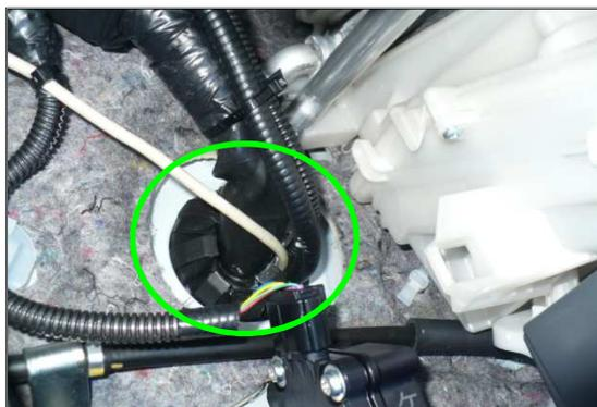
**2)** La caja de señales donde irá conectada la manguera blindada proveniente del cuadro de instrumentos irá instalada sobre la tapa de la caja de fusibles del motor, fijada mediante tornillos y precintada.
