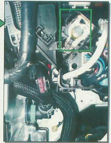
En caso de tener que montar caja de conexiones eléctricas (alimentación de taxímetro, capilla, etc), dicha caja irá instalada junto a la caja de señales (ubicada en la tapa de fusibles), fijada mediante tornillos y precintada.
