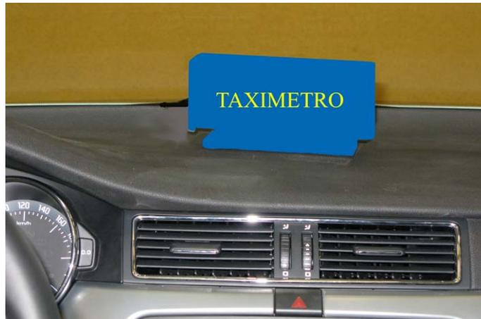
Se conecta el dispositivo impresor y se instala en la parte superior izquierda del tablero, haciendo pasar el cable por detrás del cuadro y subiéndolo por la parte externa del embellecedor izquierdo del montante A. Se recomienda retirar el embellecedor del montante A para realizar dicha operación.
