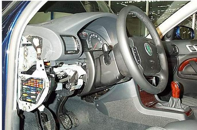
Se desmonta la tapa superior de la columna de dirección, retirando los dos tornillos en su parte inferior.
