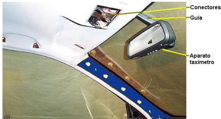
Se hace pasar el cableado del aparato taxímetro y del dispositivo impresor por debajo del imperial (por detrás del parasol izquierdo) y se hacen bajar por el montante A izquierdo (se ha de ir con cuidado para evitar que este cable no pase nunca por la parte frontal del módulo del airbag) hasta llegar a la altura de la caja de fusibles. Se conecta el aparato taxímetro a la caja de alimentación ubicada encima de los fusibles.
