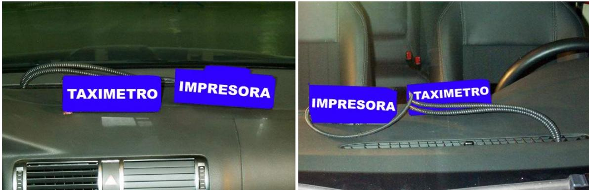
Se monta el conversor-adaptador en la guantera inferior izquierda. Se conecta en el conversor-adaptador la manguera blindada procedente del cuadro de instrumentos, la manguera blindada de retorno hacia el cable original suelto (pin 3) del cuadro de instrumentos y la manguera blindada de la salida del aparato taxímetro.
