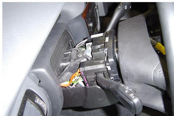
Se retiran los cuatro tornillos de la fijación del guarnecido antipolvo de la columna de dirección.
