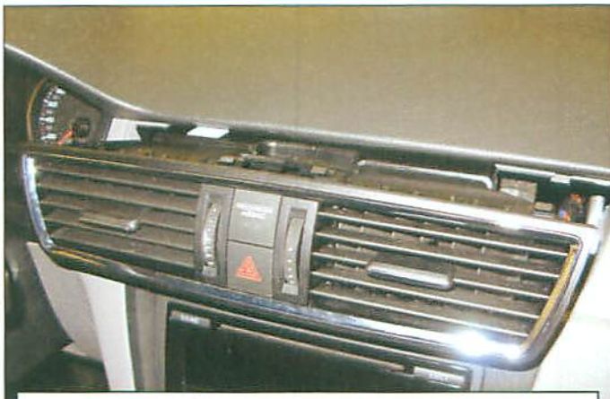
Desmontar el difusor de aire central
