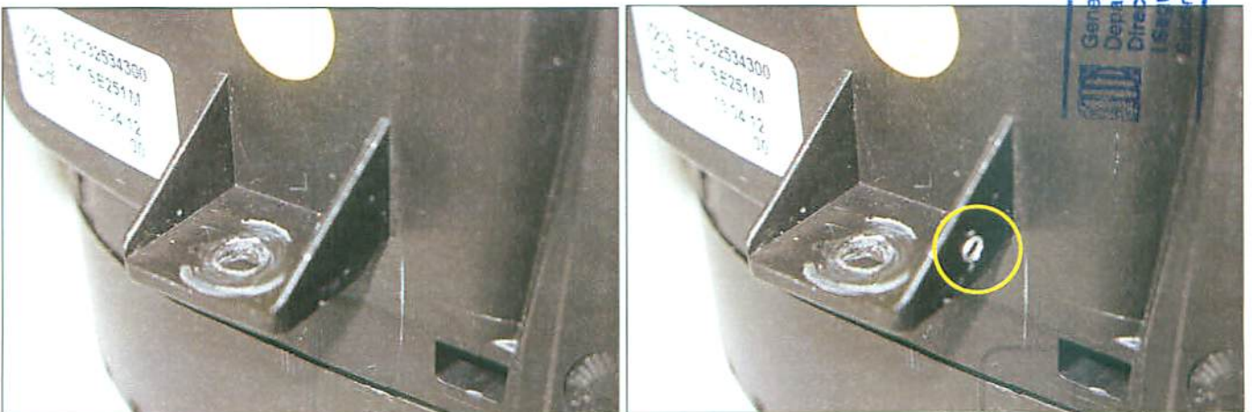
Detalle del agujero del soporte de fijación izquierdo del cuadro de instrumentos
