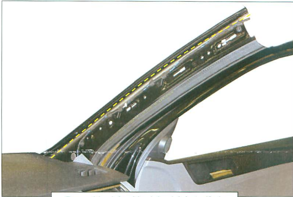
Recorrido del cable del módulo tarifario
