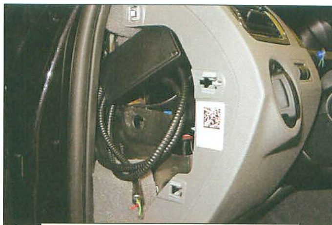
Manguera de señal de velocidad
