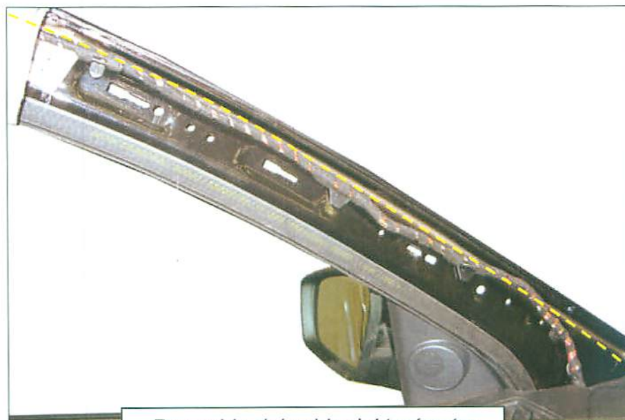
Recorrido del cable del taxímetro
