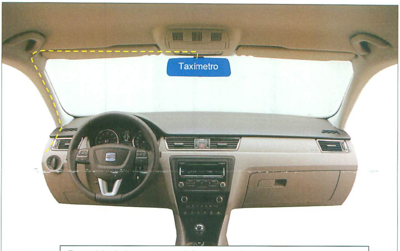
Recorrido de la manguera del taxímetro hasta el conversor adaptador
