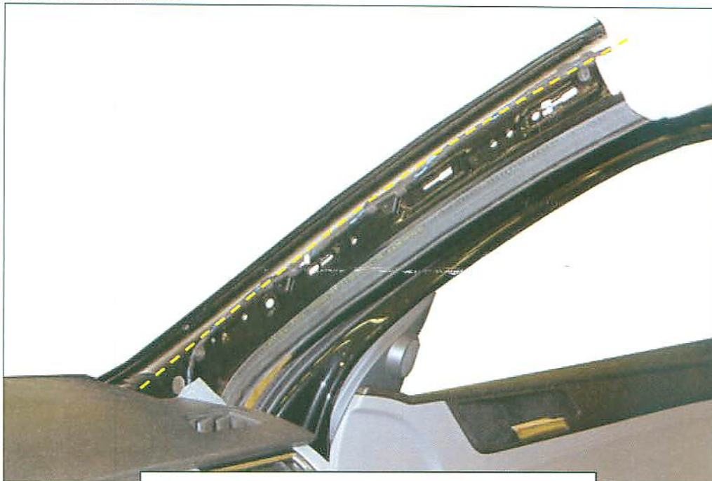
Recorrido del cable del módulo tarifario
