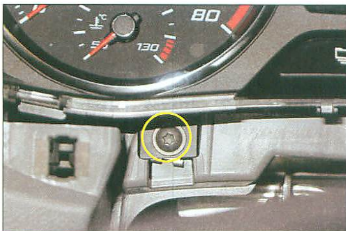
Tornillo a substituir
