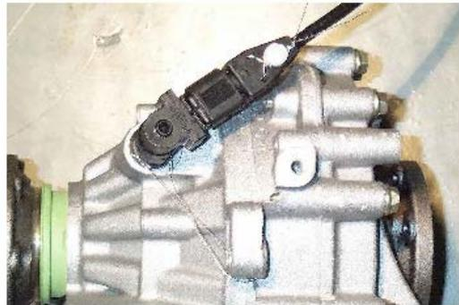
Se conecta la manguera no blindada suministrada por SEAT, S.A. con el conector no conectado proveniente del sensor de velocidad, y se pasan los dos cables por debajo del filtro de aire.
