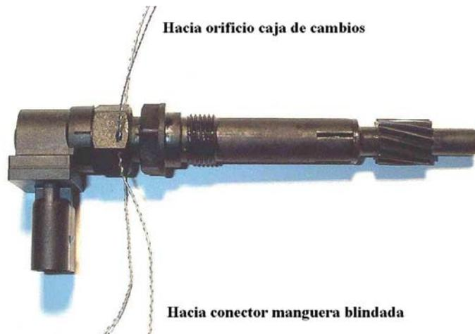
Se conecta el conector de la manguera blindada del taxímetro (con referencia B-03-00-VT o SE-TOL-5V-10.02) al sensor de velocidad y se pasa el alambre del precinto. Se precinta el conjunto.
