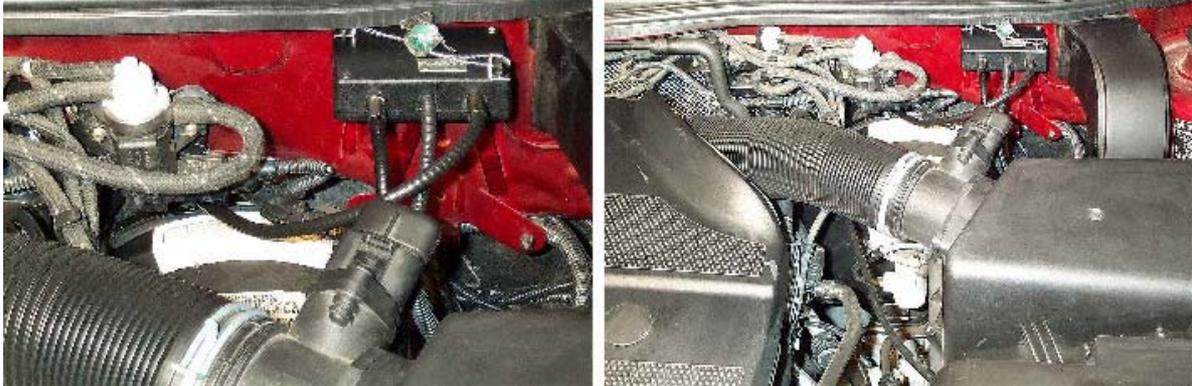
Se pasa la manguera blindada de salida hacia el taxímetro y la manguera de alimentación del taxímetro por el pasamuros (se ha de tener presente el proteger con silicona la entrada del pasamuros después del montaje de las mangueras).
