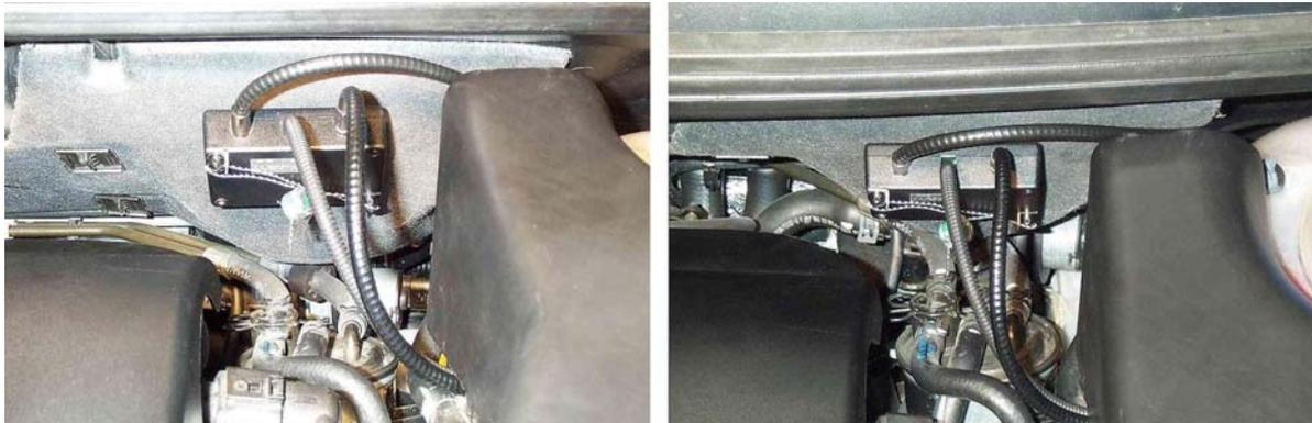
Se toma la bandeja portaobjetos central y se perfora la parte lateral izquierda y la parte superior, con unas oberturas de 15 mm x 35 mm.
