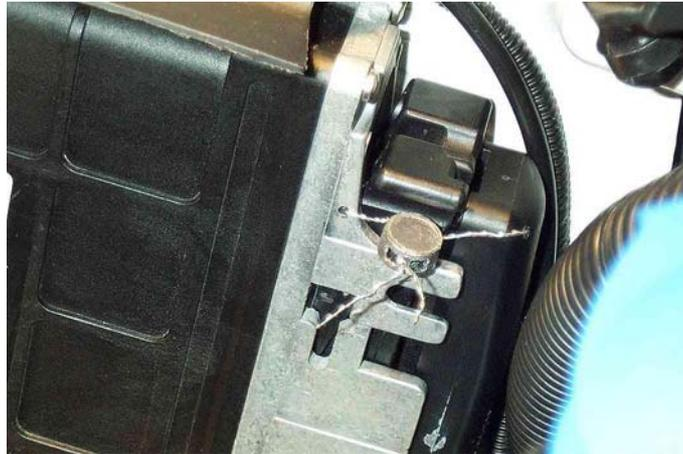
Se pasan las mangueras por delante de la batería y se conectan los cables entre sí para que funcione el cuentakilómetros del vehículo:
