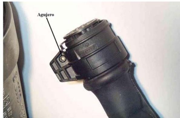
Se desmonta el tornillo de fijación de la tapa de la caja de válvulas del cambio (tercer tornillo comenzando por la parte superior) y se agujerea con un taladro de 2 mm para hacer pasar el alambre del precinto.
