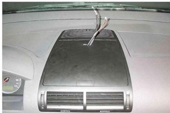
Se instala el taxímetro sobre la bandeja portaobjetos central y se conectan las mangueras. Se monta el panel inferior del tablero.
