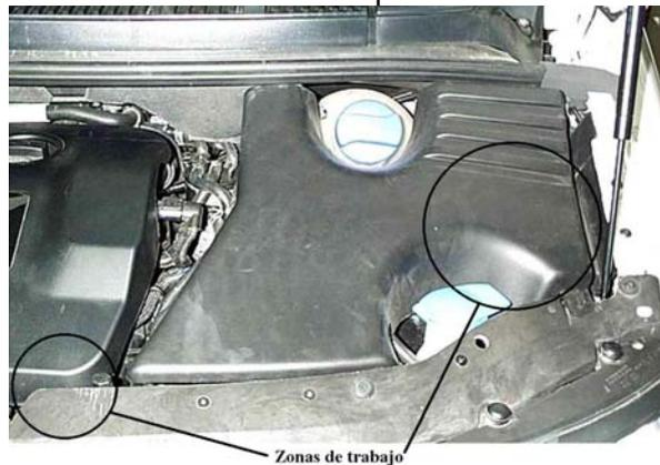
Primeramente se procede a retirar la tapa de protección de la batería:
