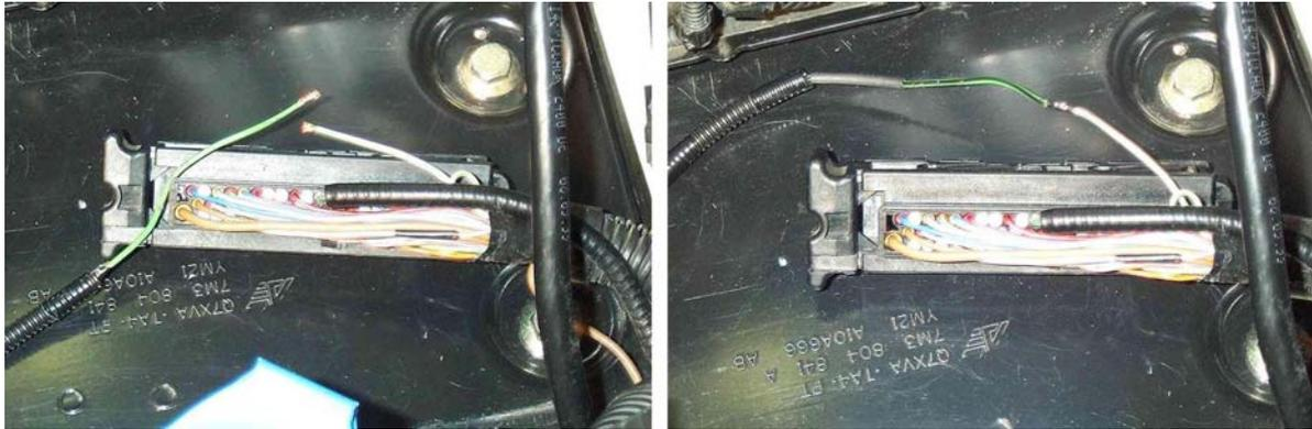
Se agujerea con un taladro de 2 mm la tapa del conector, el conector y el módulo de mando de la caja de cambios.
