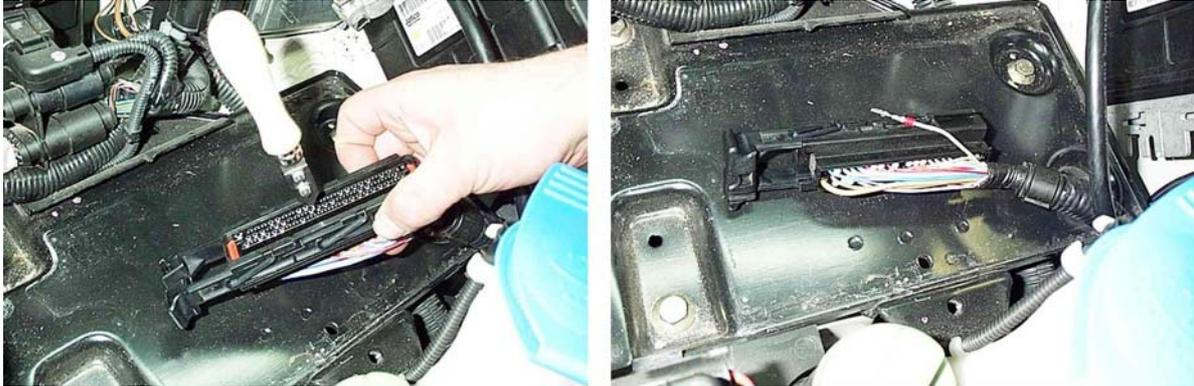
Se coge la manguera blindada y se monta un terminal en el cable verde (señal). Es recomendable cortar los tres cables sobrantes de la manguera blindada.
