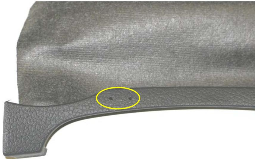
*Detalle agujeros cubierta de la columna de dirección*
