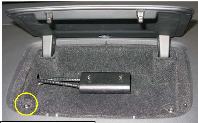
*Tornillo a substituir*
