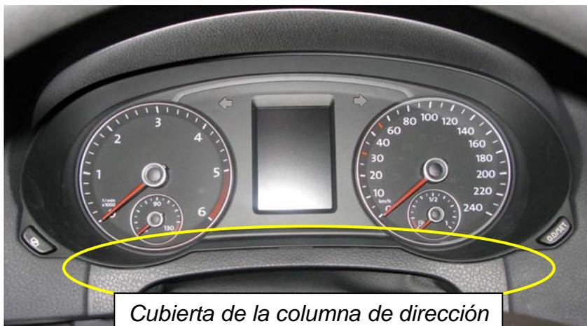
*Cubierta de la columna de dirección*
