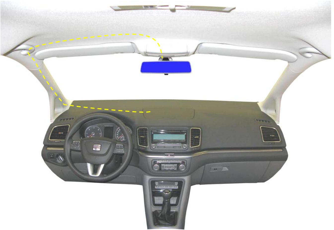
*Recorrido de la manguera del taxímetro hasta el conversor adaptador*
