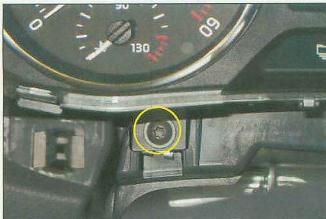
*Tornillo a substituir*
