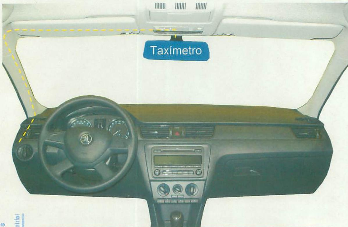
*Recorrido de la manguera del taxímetro hasta el conversor adaptador*
