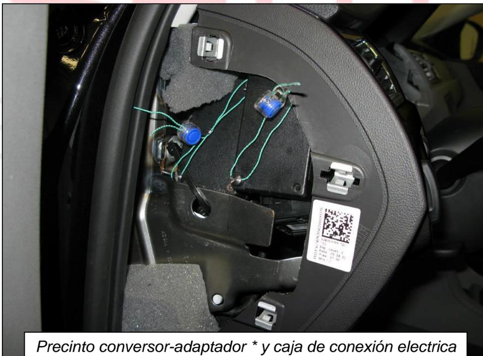
*Precinto conversor-adaptador \* y caja de conexión eléctrica
