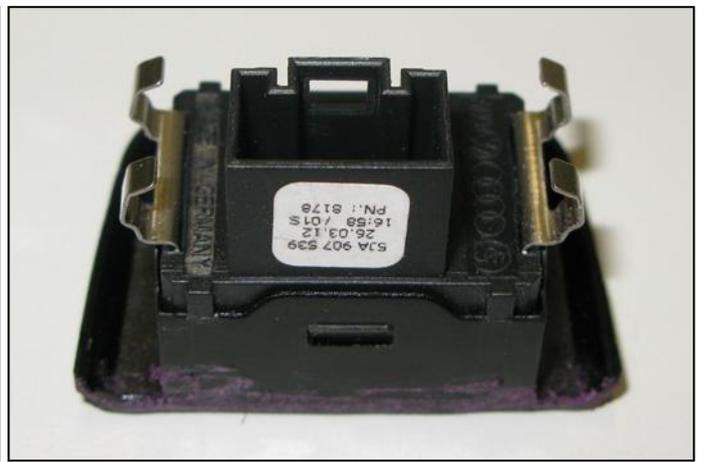
**A2)** En la parte anterior del alojamiento del sensor solar, practicar una abertura de 10mm sobre toda su longitud para dejar hueco para el paso de las mangueras blindadas.
