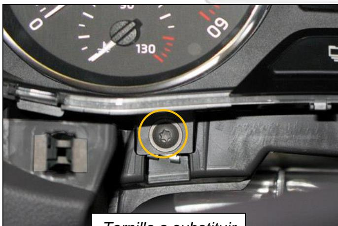
*Tornillo a substituir*
