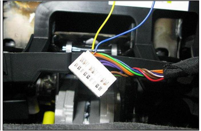
**11)** Conectar la manguera blindada a la salida taquimétrica del adaptador Can-Bus. Montar el adaptador Can-Bus en el hueco izquierdo del alojamiento del cuadro de instrumentos y fijar la manguera blindada con una brida. Conectar la alimentación del adaptador Can-Bus a la caja de conexión eléctrica.
