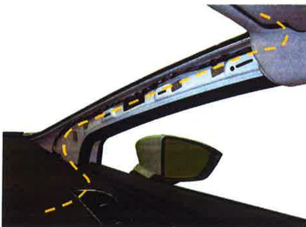
Desmontar el guarnecido del montante A derecho y remover el guarnecido del techo. Pasar el cable del módulo según indicado adjunto y hacerle llegar hasta la parte delantera central del techo. Volver a montar el guarnecido.
