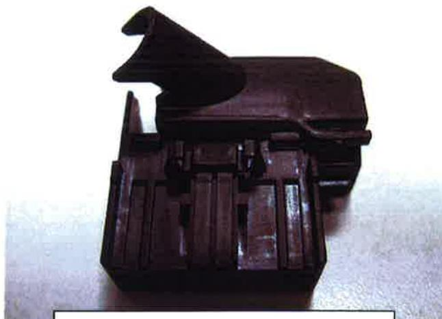
Conector 4A0.972.883.C para la conexión a la unidad de control
