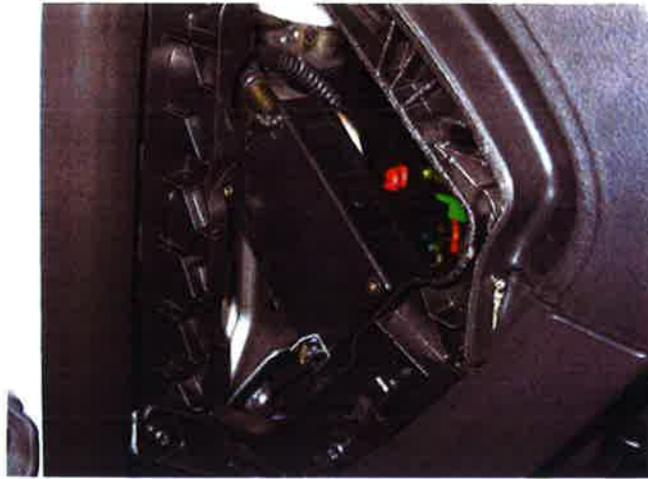
La caja de conexión eléctrica instalada se utilizará como único y exclusivo punto de suministro para los equipos metrológicos del taxi (taxímetro, conversor-adaptador <sup>(1)</sup>, impresora y módulo tarifario), etc...
