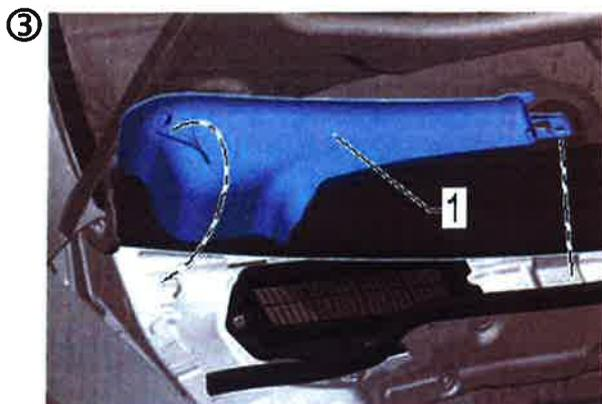
Desmontar la cubierta de la rejilla de entrada de aire (1) aflorando los 2 tornillos.
