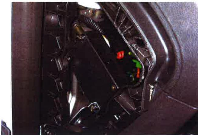
Caja de conexión eléctrica en el alojamiento de la cubierta izquierda
