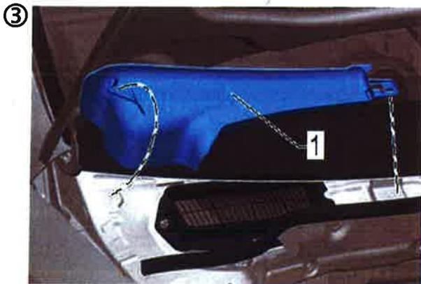
Desmontar la cubierta de la rejilla de entrada de aire (1) aforando los 2 tornillos.
