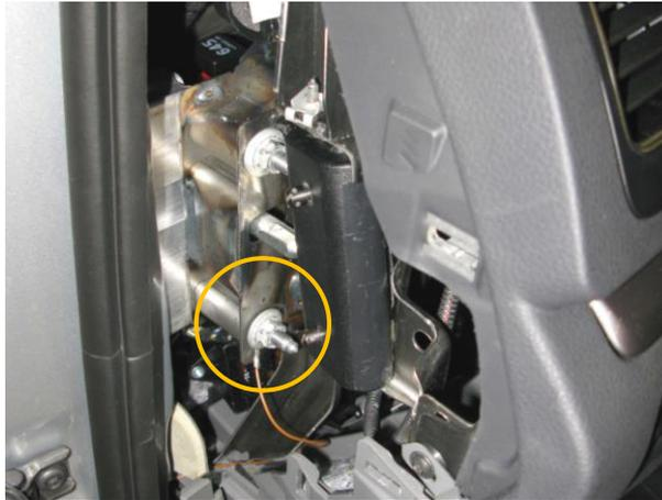
*Cable de masa y caja de conexión eléctrica*
