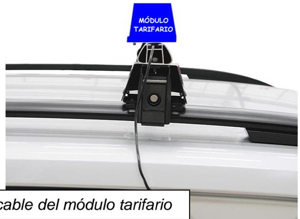
*Emplazamiento y paso del cable del módulo tarifario*
