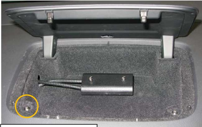
Tornillo a substituir
