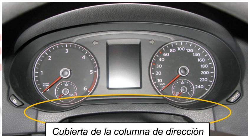
*Cubierta de la columna de dirección*
