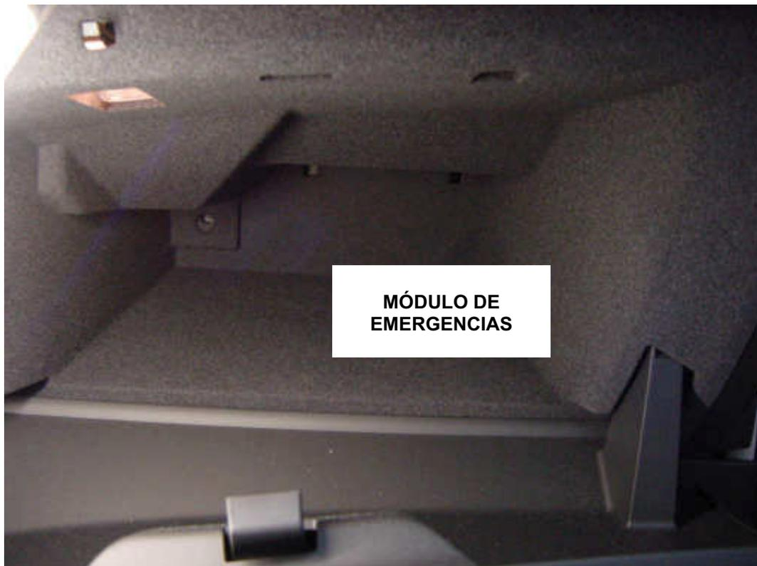
*Fig. 10.1. Vista del emplazamiento del módulo de emergencias.*
