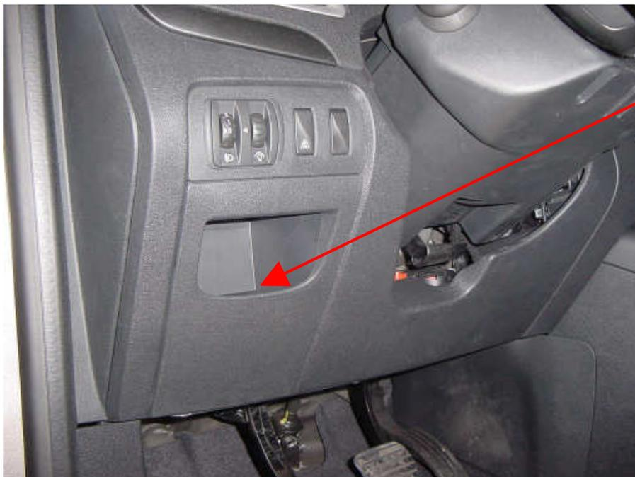
Tapa protectora de la caja de fusibles y del conector R-107.
