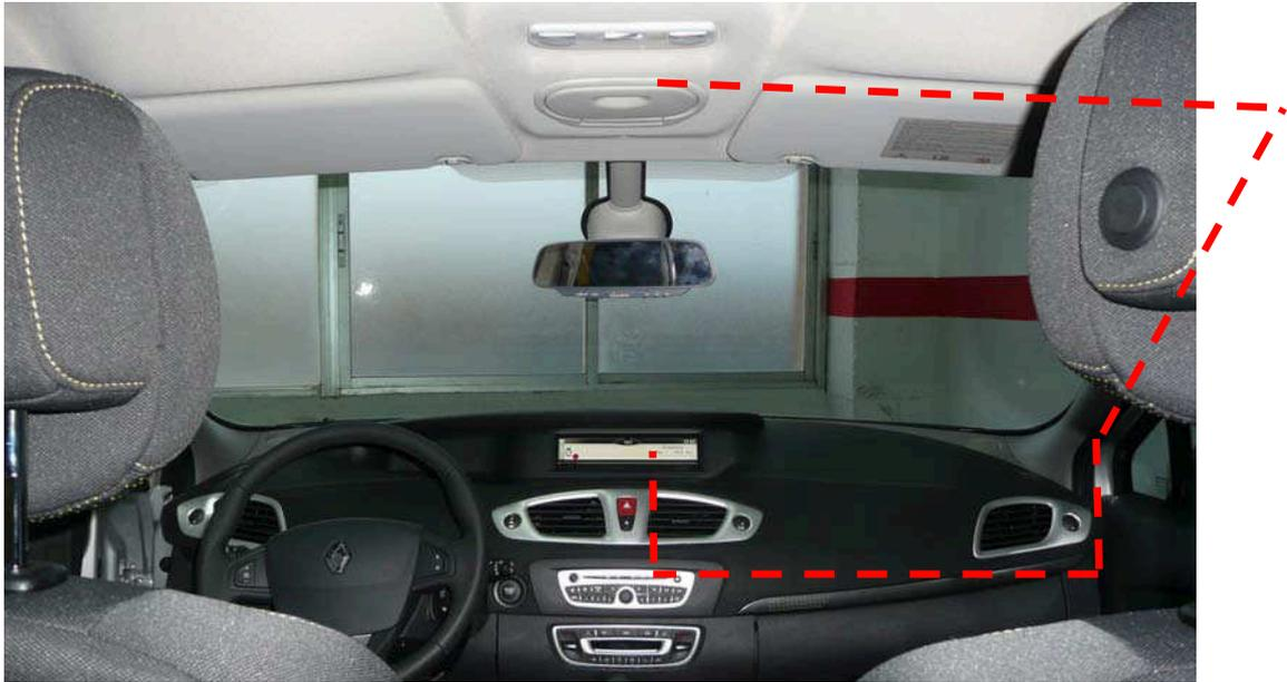
*Fig. 9.2. Recorrido de cable del módulo sobre techo*
