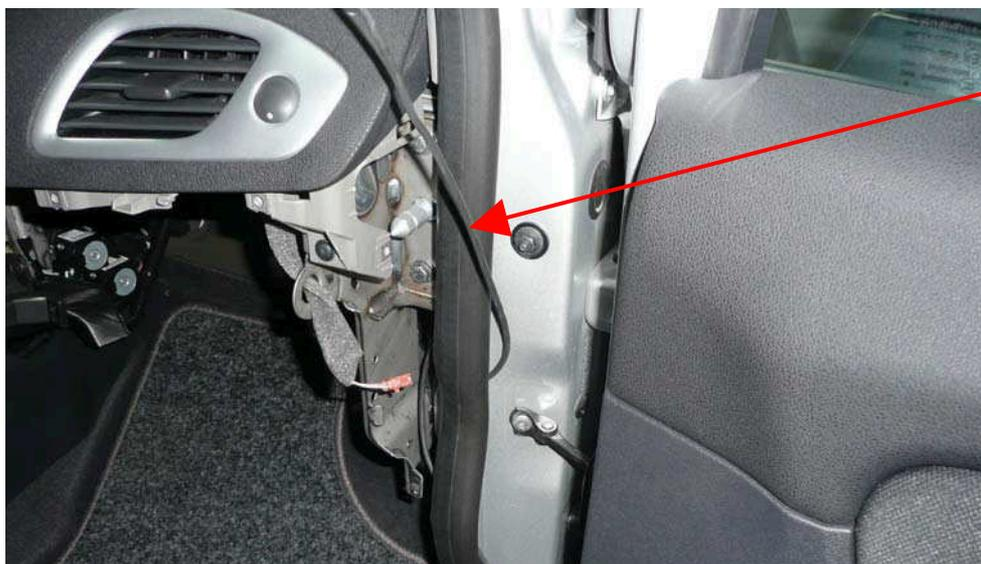
*Fig. 9.3. Vista del paso del cable para modulo exterior sobre barras.*
