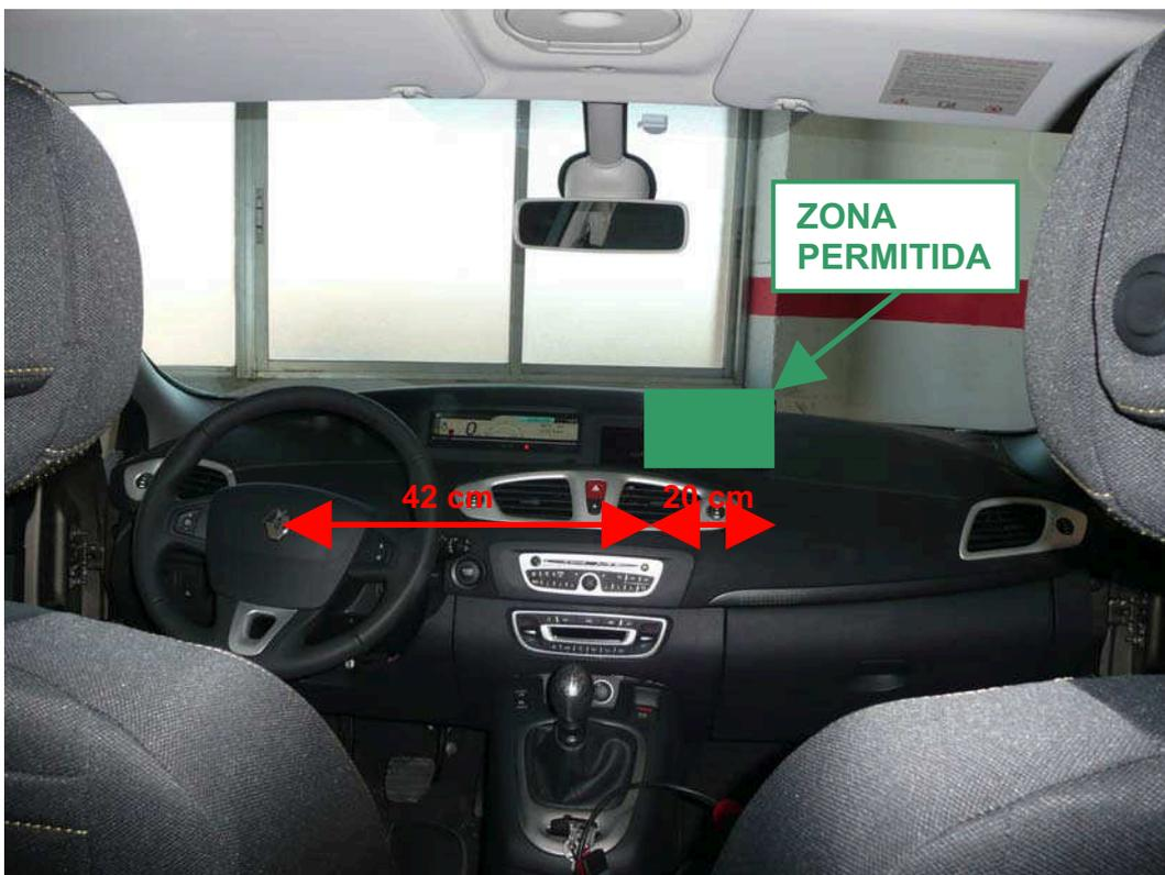
*Fig. 4.1. Vista de la zona permitida para la instalación del taxímetro.*
