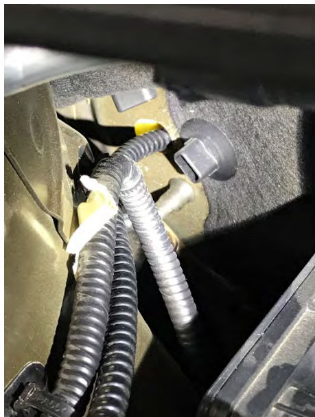
Fig. 2.2. Detalle paso cable de señal, detrás de la zona de la guantera, vista motor y habitáculo
