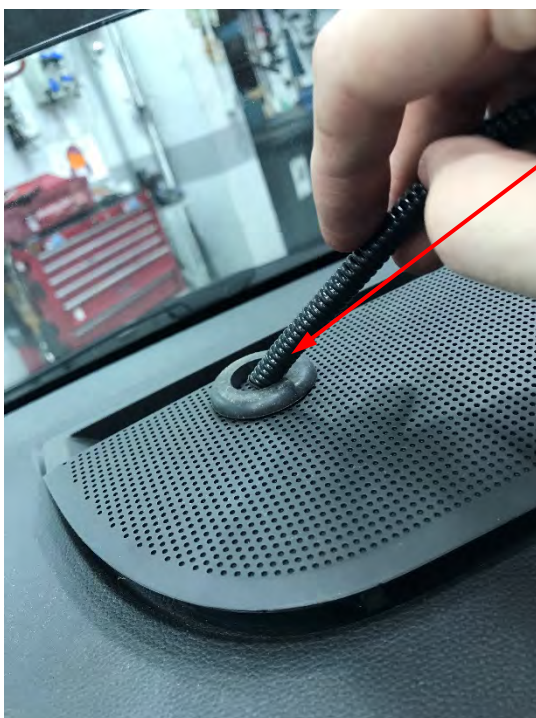
Fig. 4.3. Vista del paso de la manguera al habitáculo
