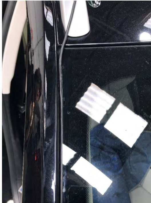
Fig. 6.5. Vistas del recorrido del cable por el marco del parabrisas
