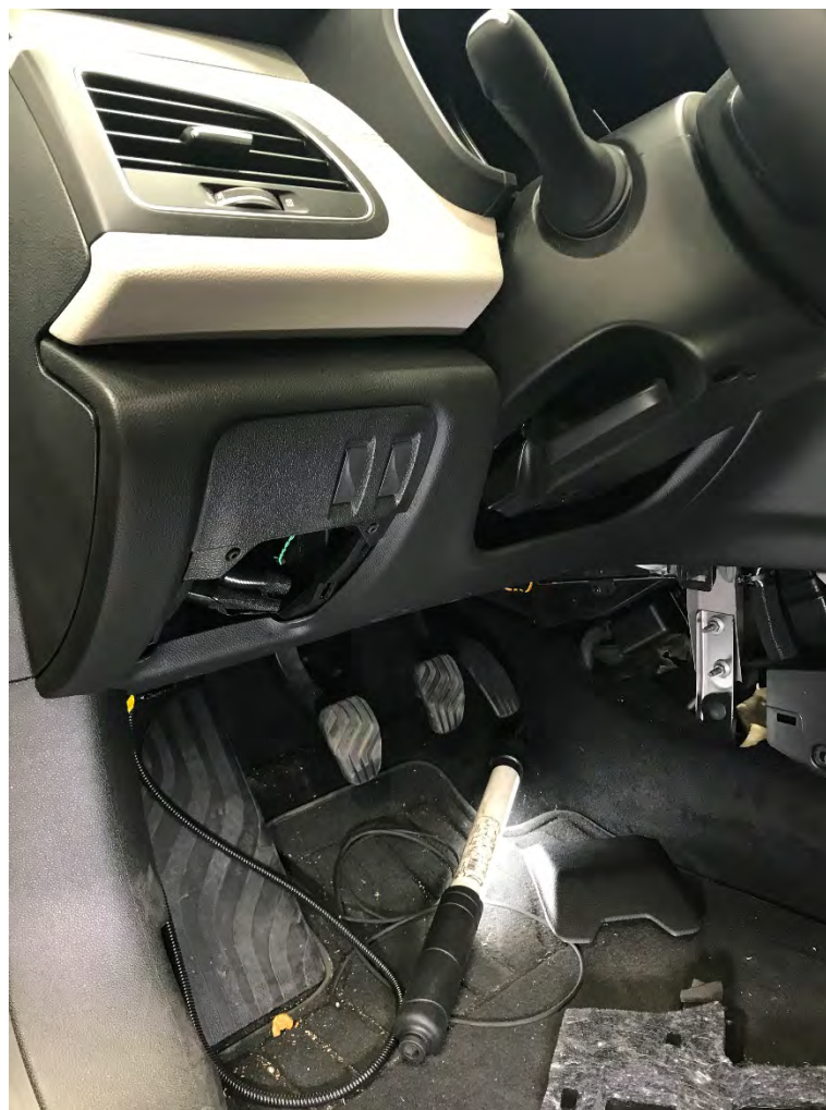
Fig. 3.1. Vista de la terminación de la manguera blindada puesta por el concesionario
