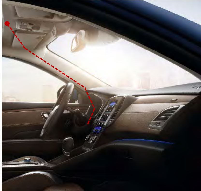
Fig. 6.2. Vista recorrido del cableado entre el módulo y la caja adaptadora de señal
