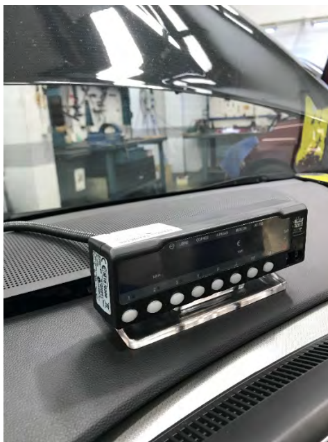
Fig. 5.1. Ubicación taxímetro consola centrado sobre salpicadero.
