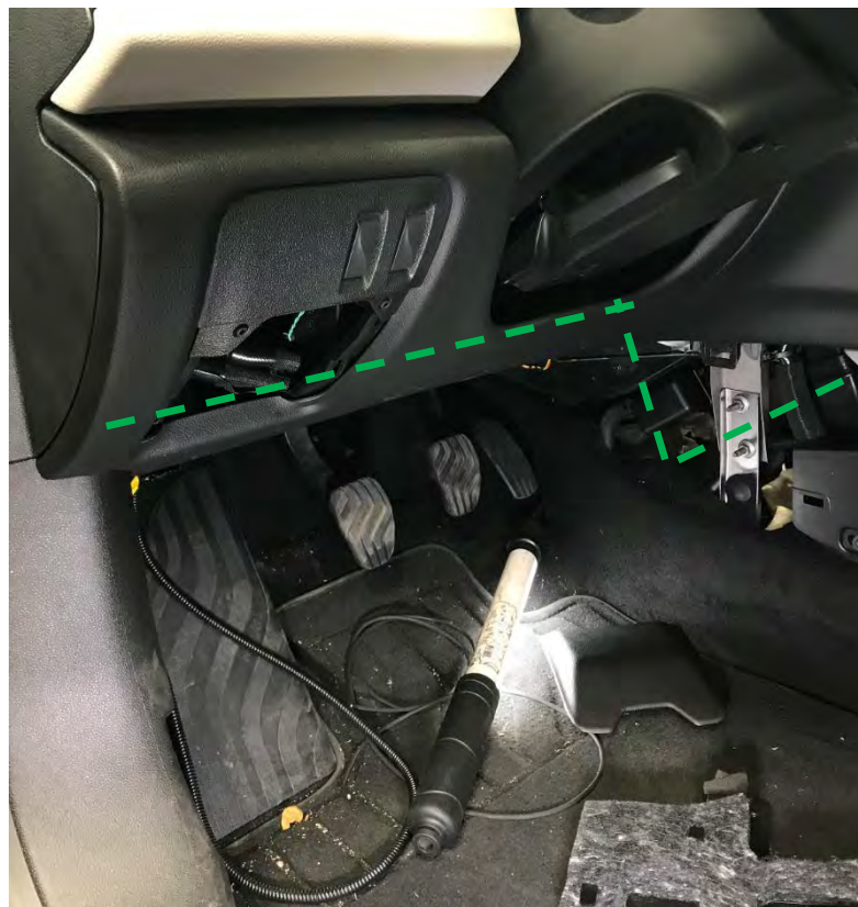
Fig. 2.5 y 2.6. Recorrido de la manguera blindada por debajo del guarnecido del salpicadero hasta el compartimento de la caja de fusibles
