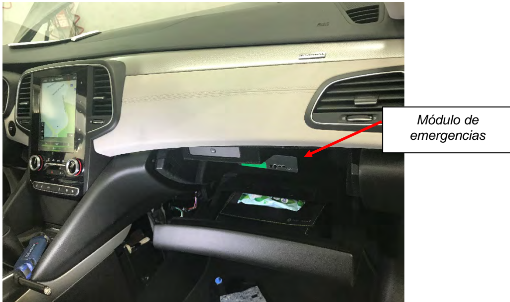
Fig. 7.1. Vista del emplazamiento del módulo de emergencias.
