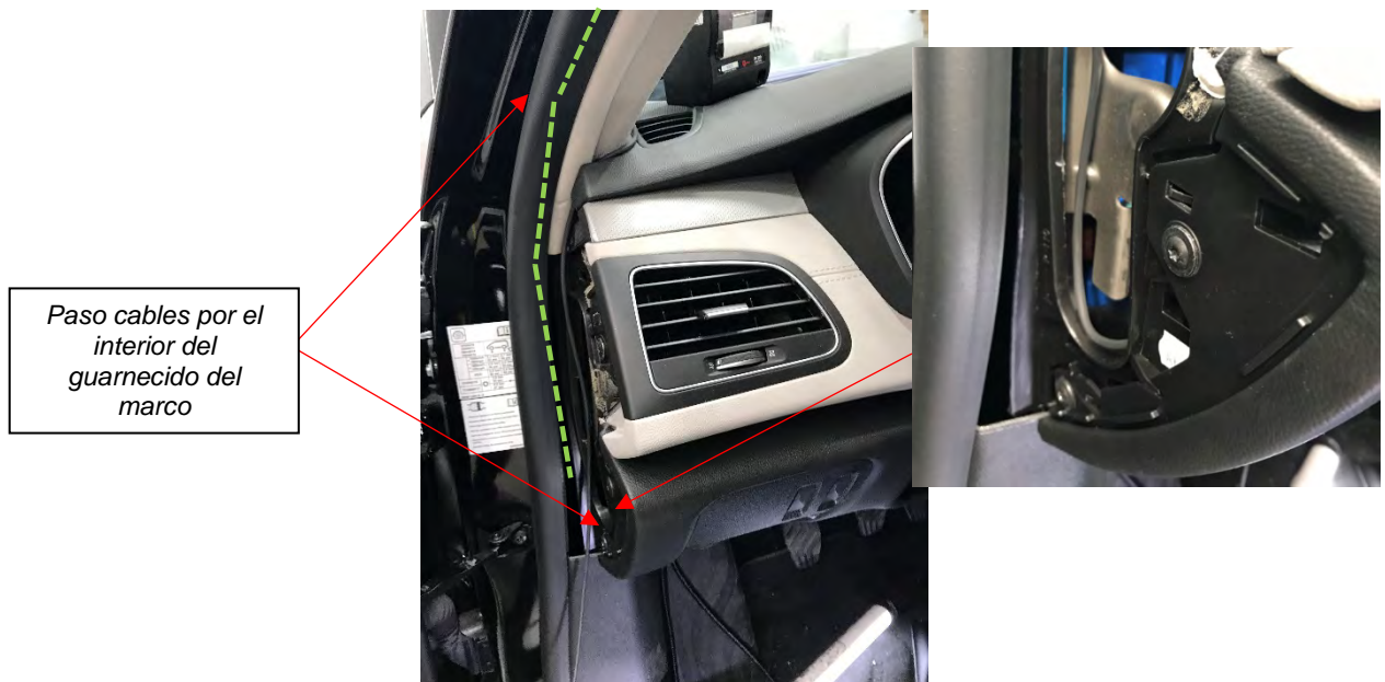
Fig. 4.5. Paso de cables del taxímetro de espejo a la caja adaptadora.
