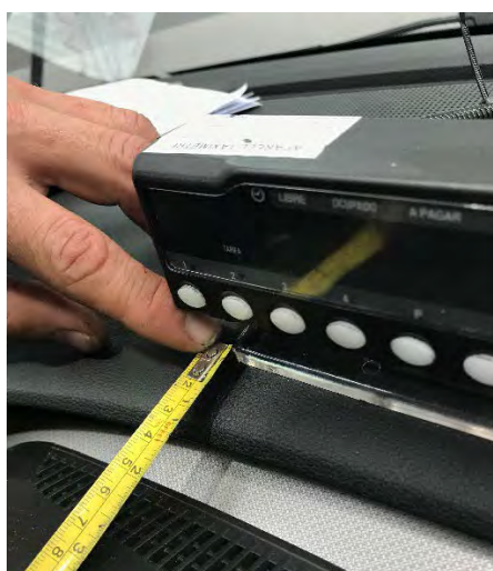
Fig. 5.2. Separación taxímetro a borde salpicadero.
