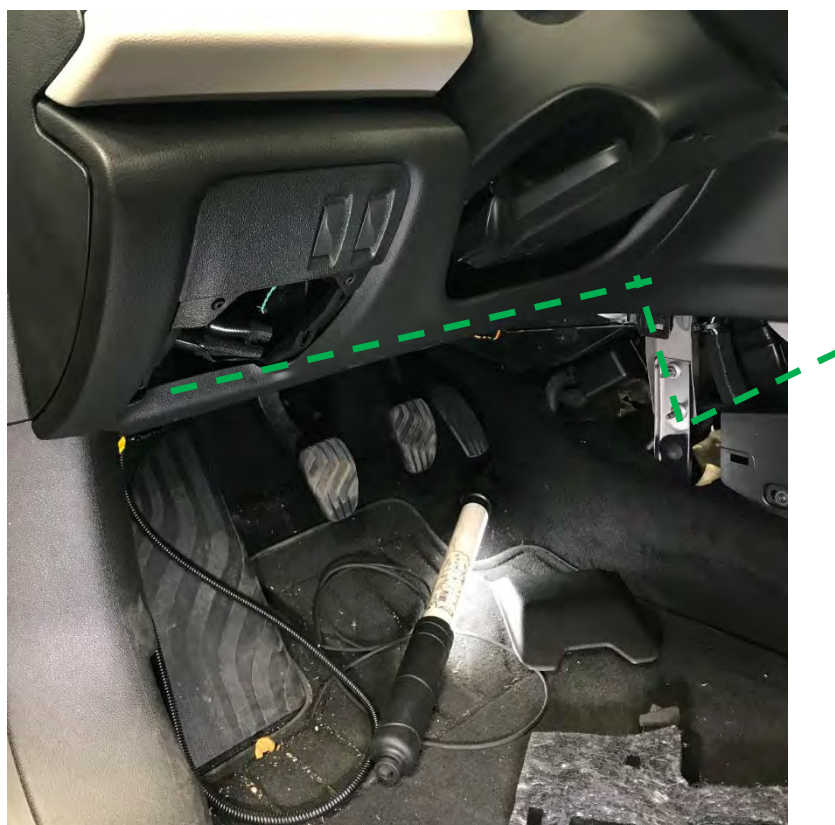
Fig. 7.2 y 7.3. Recorrido de la manguera blindada del módulo hasta la caja de conexiones por debajo del guarnecido del salpicadero
