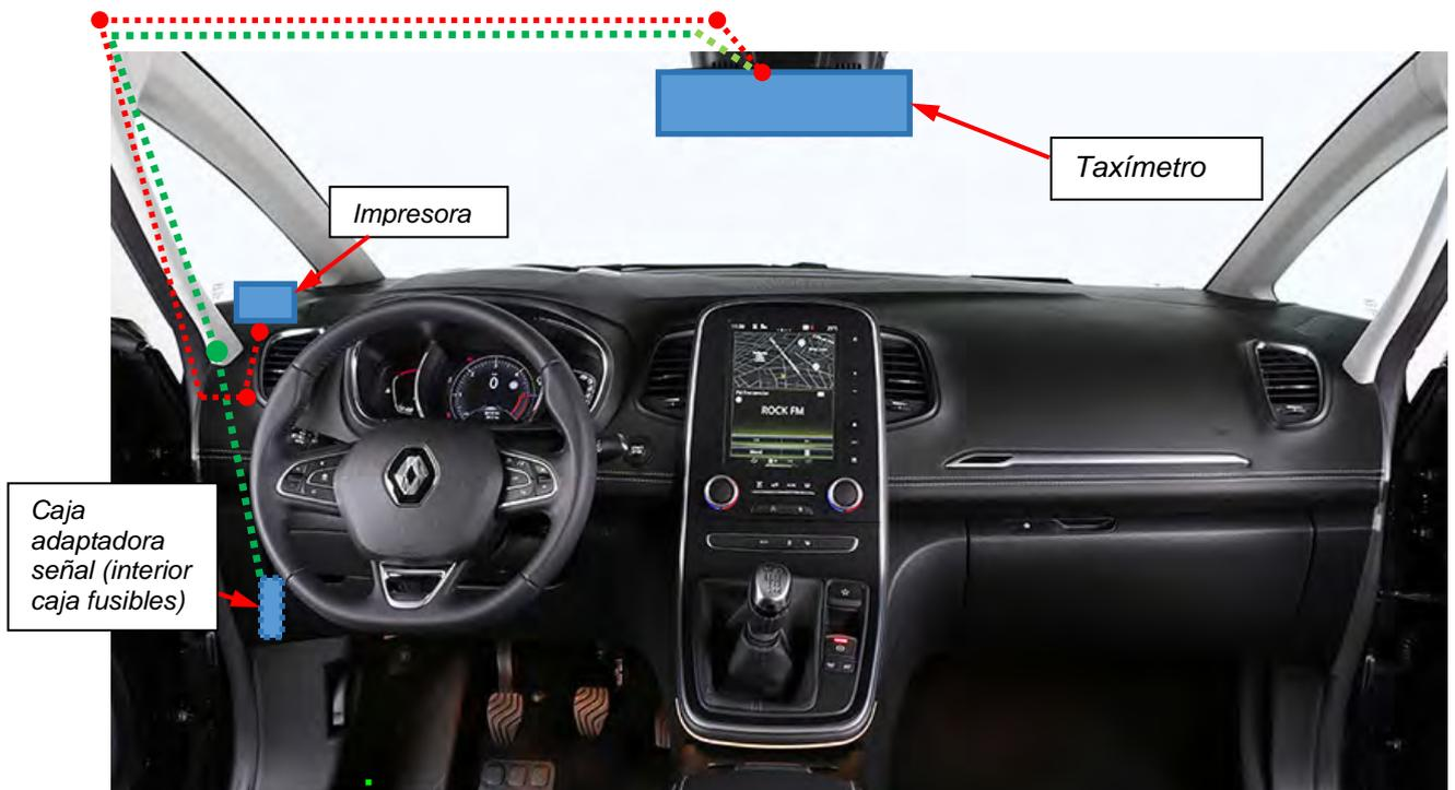
*Fig. 4.1. Esquema orientativo de las conexiones.*
