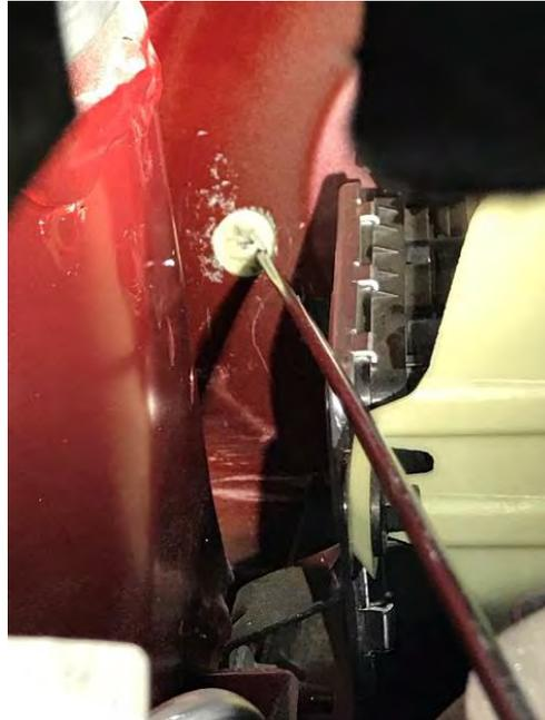
*Fig. 2.3. Detalle pasamuros junto al módulo ABS/ESP*
