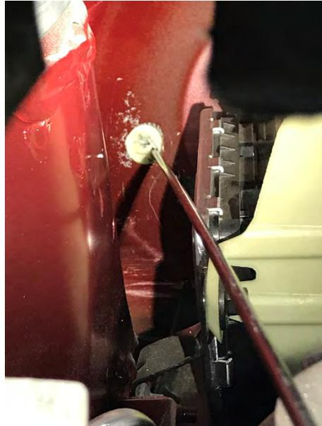
*Fig. 2.2. Detalle pasamuros junto al módulo ABS/ESP*
