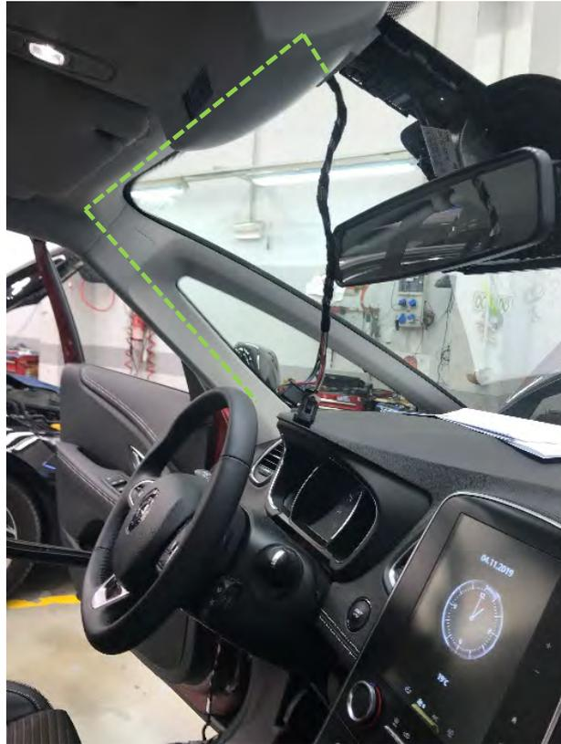
**Fig. 4.4.** Recorrido de los cables por el interior del guarnecido del techo
