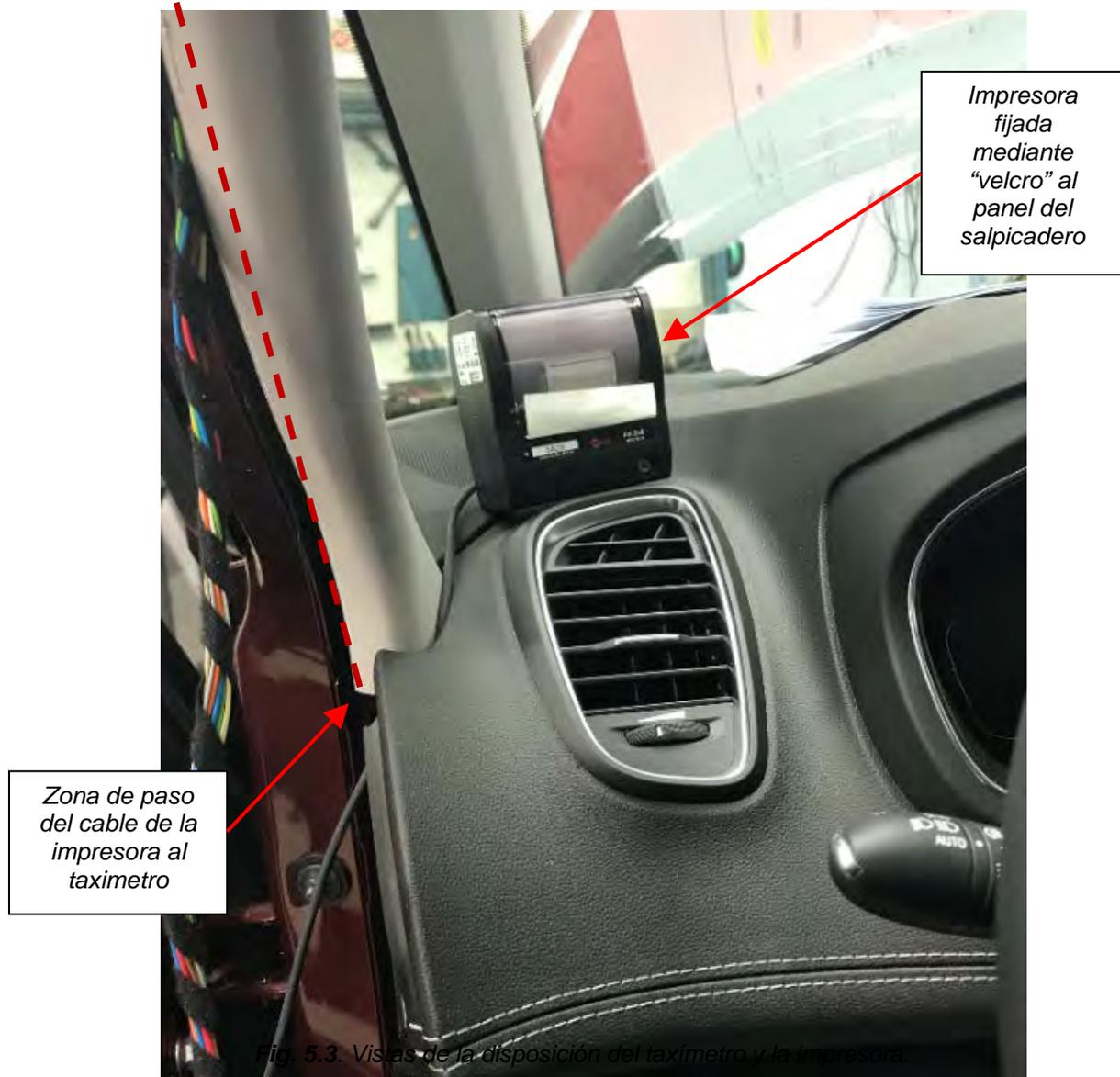
**Fig. 5.3.** Emplazamiento y conexionado de la impresora.
