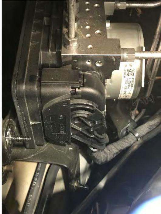
*Fig. 1.3. Detalle conector 1094 módulo ABS/ESP*
