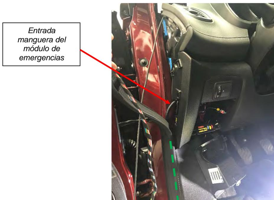
**Fig. 7.2.** Recorrido de la conexión módulo de emergencias.
