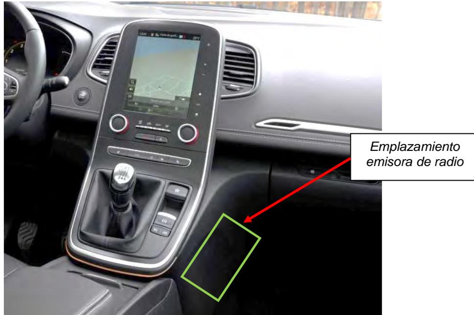
**Fig. 7.3.** Vista del emplazamiento de la emisora de radio
