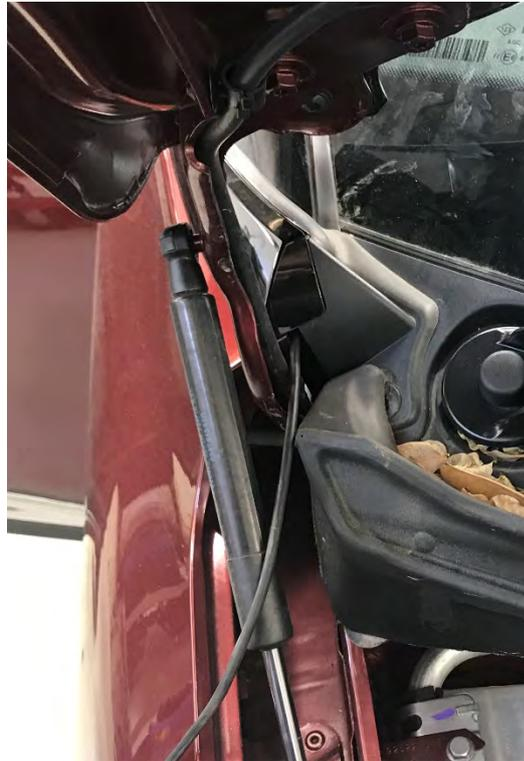
*Fig. 6.5. Vista del paso de cable del módulo al compartimento motor*
