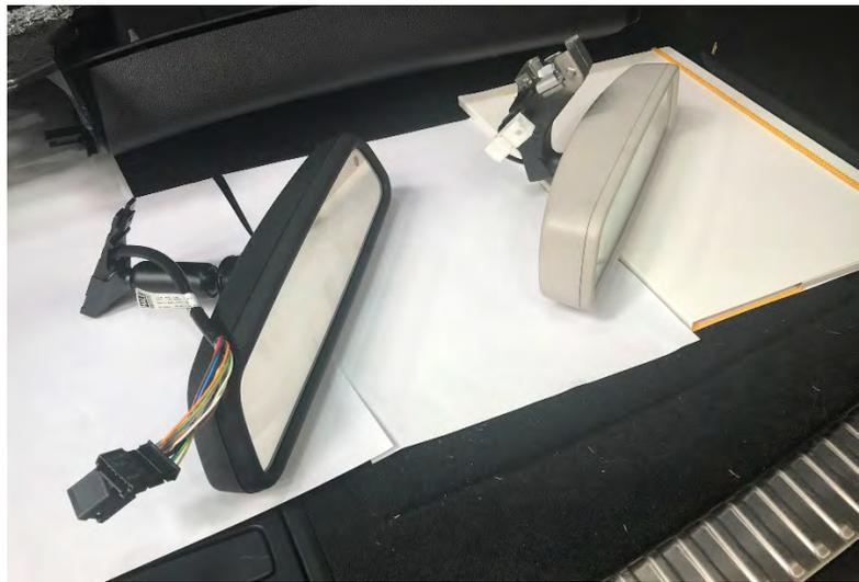
*Fig. 5.1. Taxímetros de espejo y original del vehículo sustituido.*
