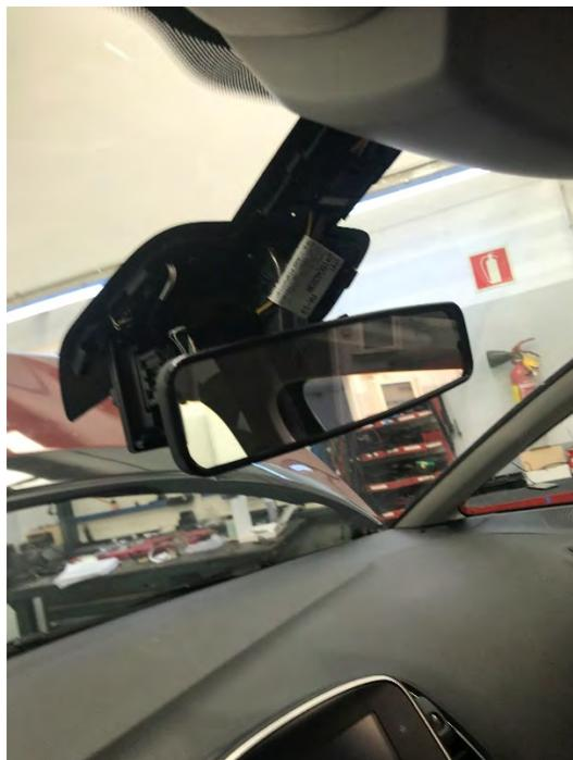
*Fig. 5.2. Vista del taxímetro de espejo.*
