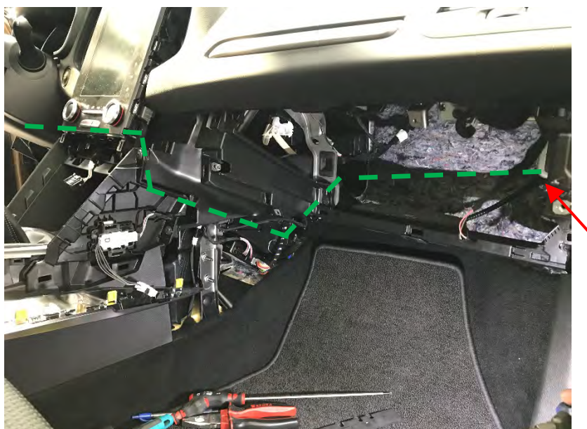
Fig. 2.4. Detalle paso cable de señal por detrás de la guantera y recorrido del cable por el interior del guarnecido bajo el salpicadero
