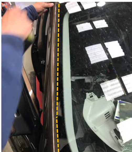
Fig. 6.5 y 6.6. Vistas del paso de cable del módulo al compartimento motor
