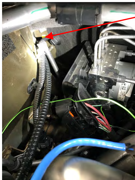
Fig. 2.2. Detalle pasamuros junto al módulo ABS/ESP, vista compartimento motor
