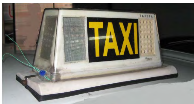
Fig. 6.3. Vista del módulo y su precinto
