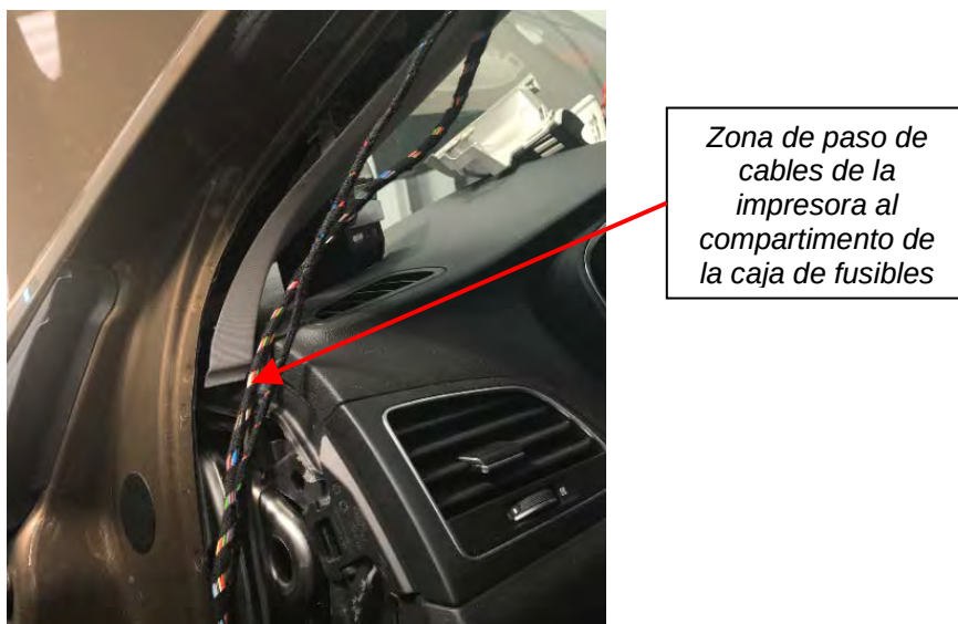
Fig. 5.7. Vistas de la disposición de la impresora.
