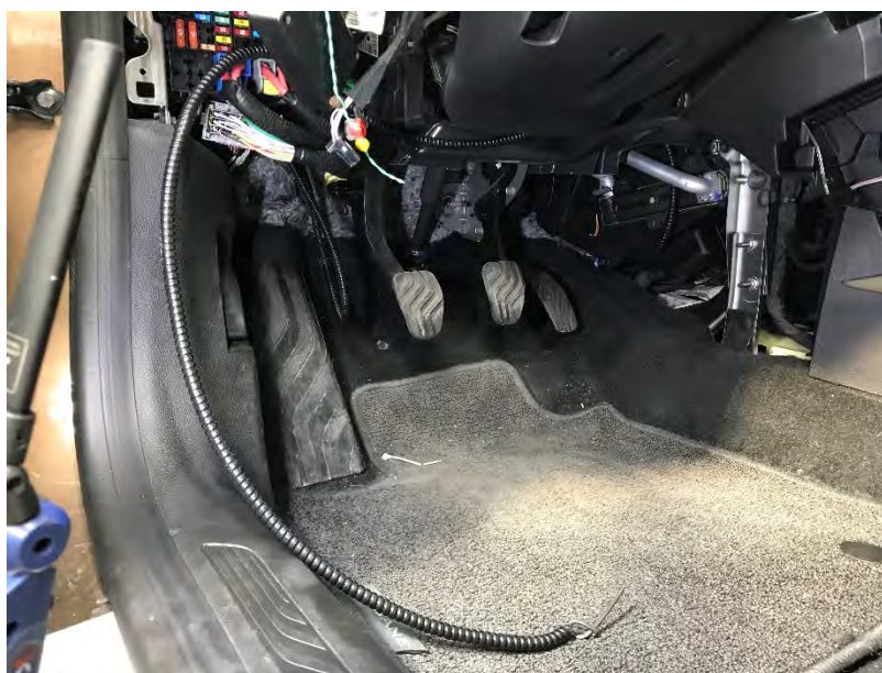
Fig. 3.1. Vista de la terminación de la manguera blindada puesta por el concesionario
