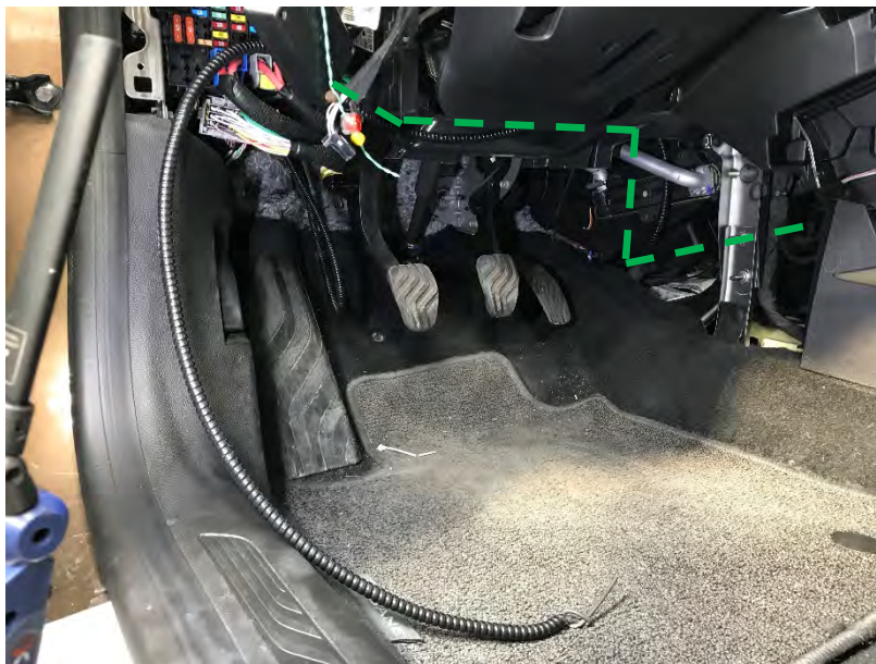
Fig. 2.5. Detalle recorrido del cable por el interior del guarnecido bajo el salpicadero hasta el compartimento de la caja de fusibles
