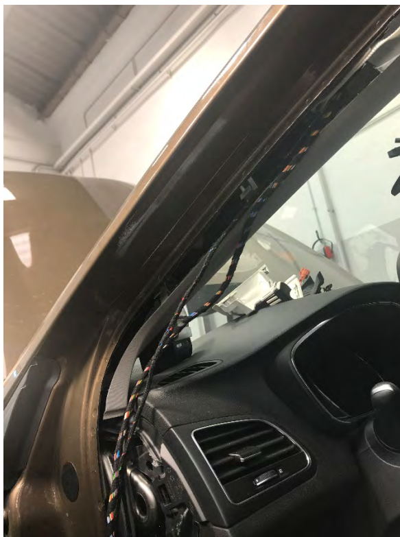
Fig. 6.2. Vista recorrida del cableado entre el módulo y la caja adaptadora de señal
