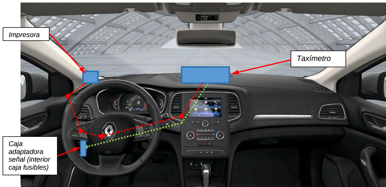
Fig. 4.1. Esquema orientativo del recorrido de las conexiones para taxímetros sobre salpicadero .
