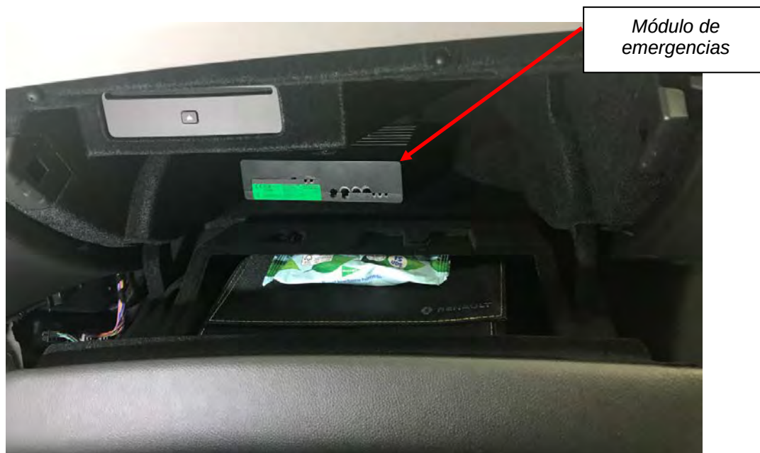
Fig. 7.1. Vista del emplazamiento del módulo de emergencias.
