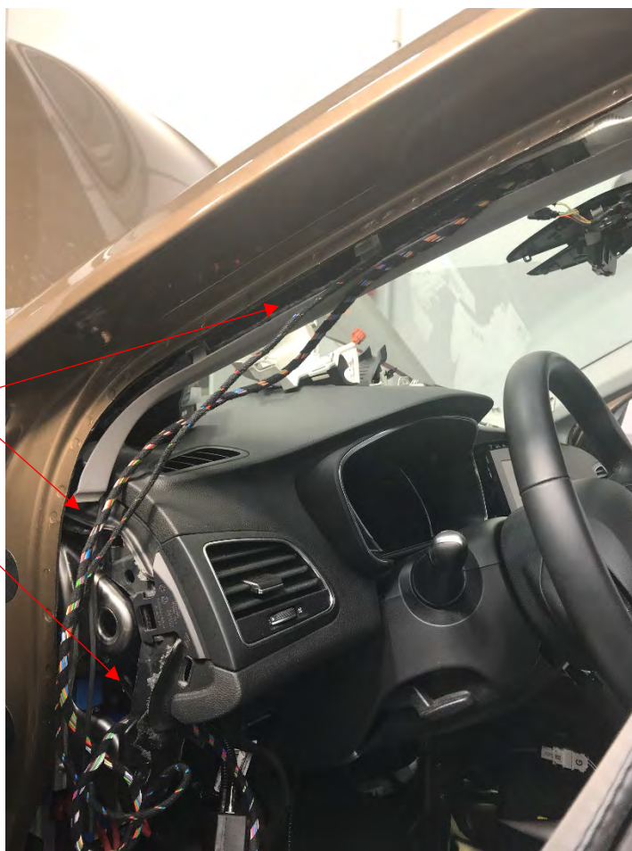
Fig. 4.6. Entrada de cables al interior del salpicadero.
