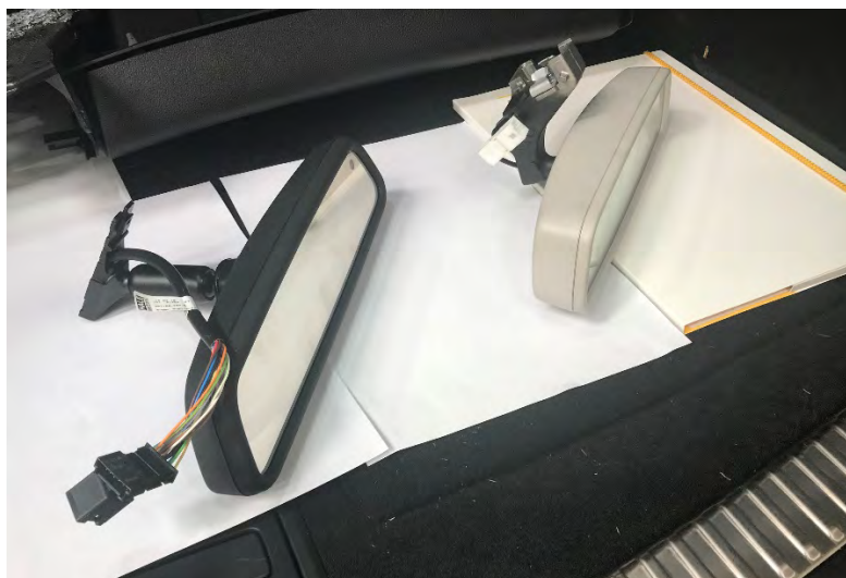
Fig. 5.3. Taxímetros de espejo y original del vehículo sustituido.
