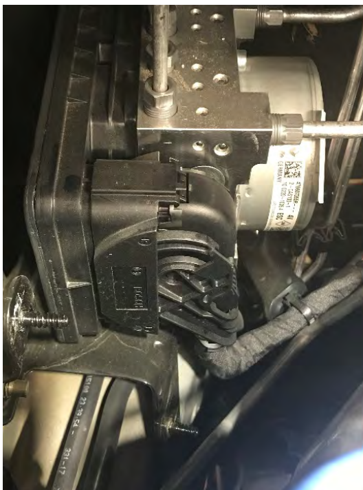
Fig. 1.3. Detalle conector 1094 módulo ABS/ESP
