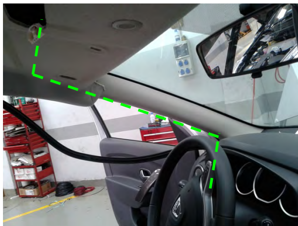
Fig. 6.3. Vista recorrido del cableado entre el módulo y la caja adaptadora de señal
