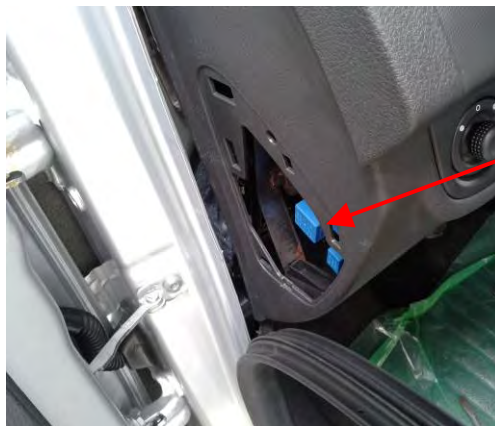
Fig. 4.1. Vista del paso de la manguera blindada desde el conector 261 hasta la caja de fusibles
