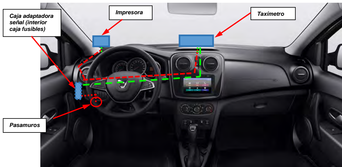
Fig. 4.1. Esquema orientativo de las conexiones para taxímetro de consola.
