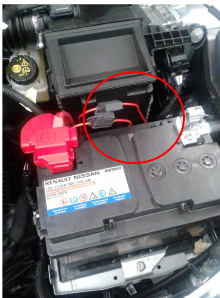
Fig. 2.1. Vista del fusible exterior
