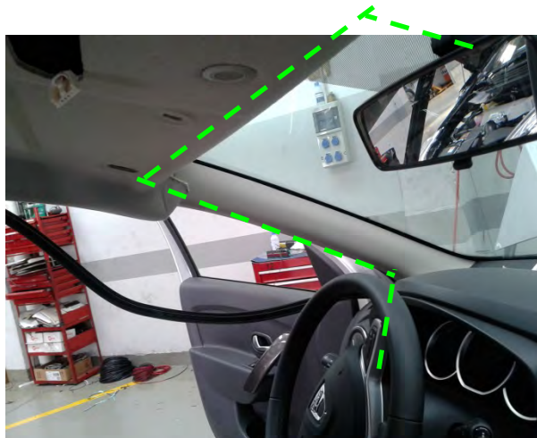
Fig. 4.6. Vista recorrido del cable del taxímetro de espejo y la caja adaptadora de señal
