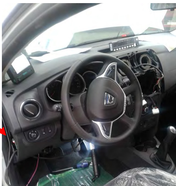
Fig. 4.7. Vista recorrido del cableado entre el módulo y la caja adaptadora de señal
