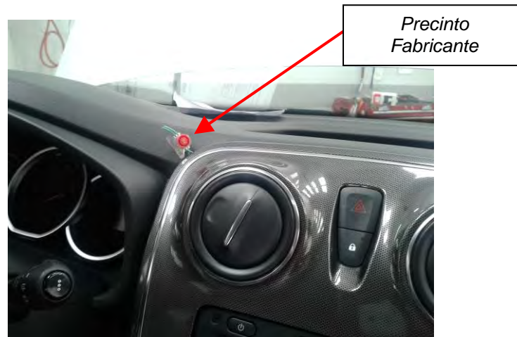
Fig. 3.1. Vista de la disposición del precintado de la consola central, Fabricante
