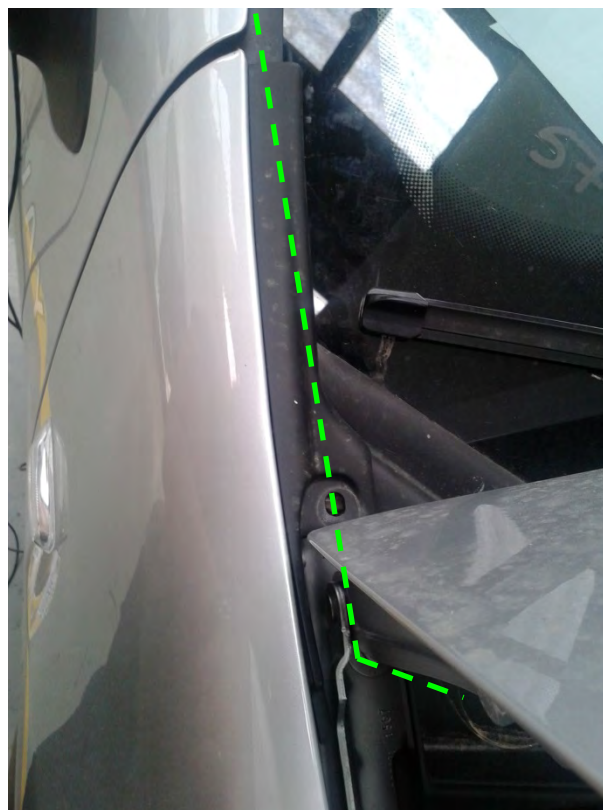
Fig. 6.5. Vista del paso de la manguera al compartimento motor
