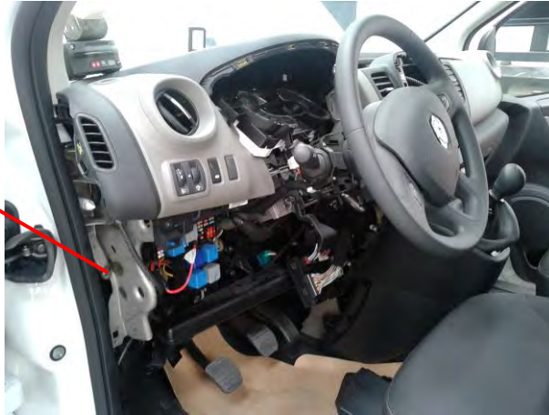
Fig. 1.5. Vista de la ubicación de la caja de fusibles
