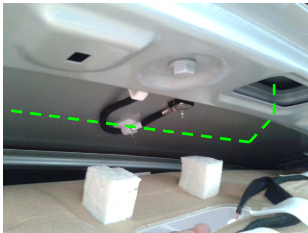
Fig. 6.2. Vista paso del cableado por el interior del techo
