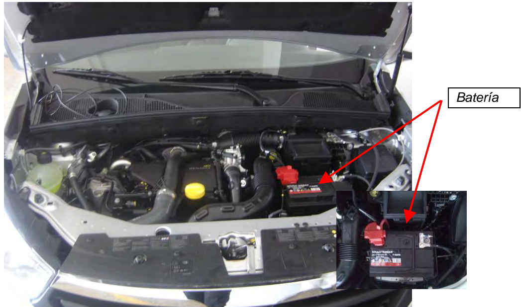
Fig. 1.3. Vista del alojamiento motor. Ubicación de la batería.
