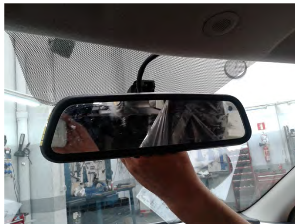
Fig. 4.5. Vistas de la disposición del taxímetro de espejo.
