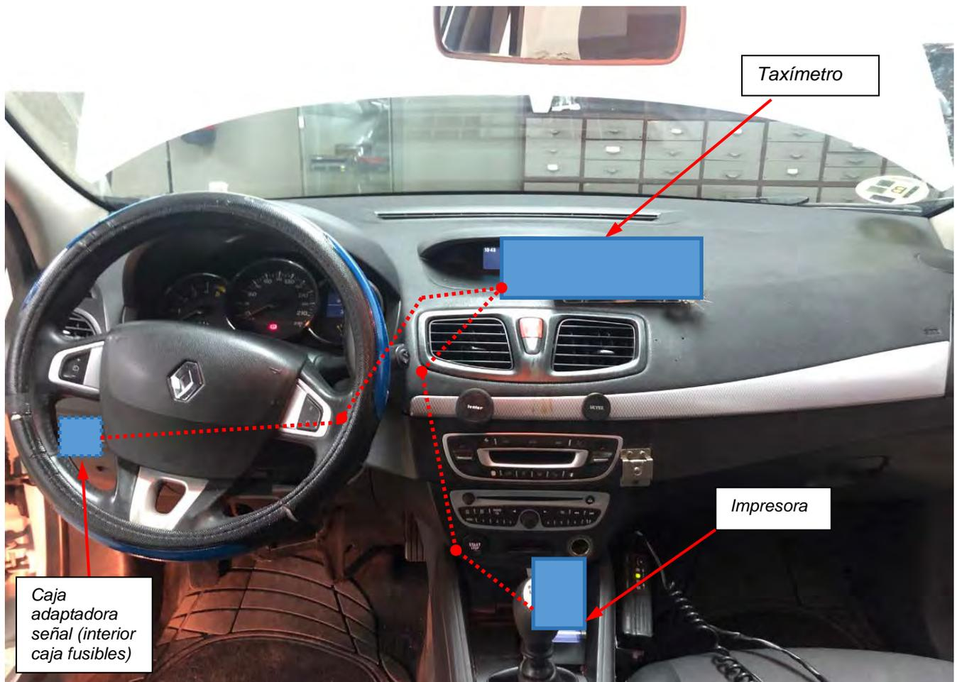
**Fig. 4.1.** Esquema orientativo del recorrido de las conexiones para taxímetros en salpicadero .
