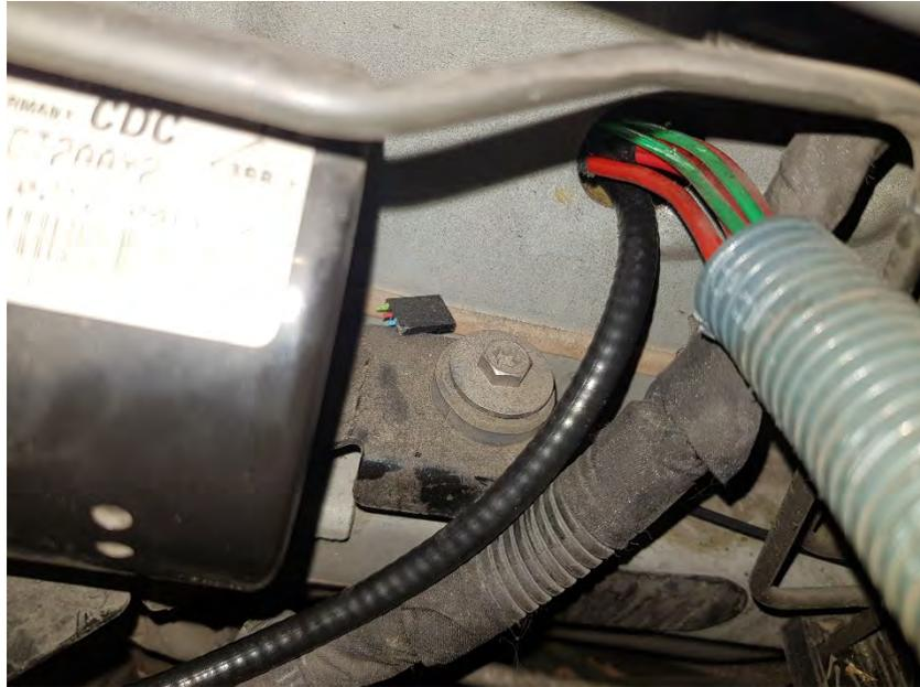
*Fig. 1.7. Detalle pasamuros, vista compartimento motor*
