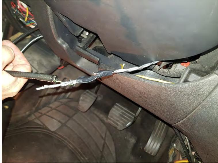
**Fig. 3.2.** Vista del recorrido de la manguera al taxímetro.
