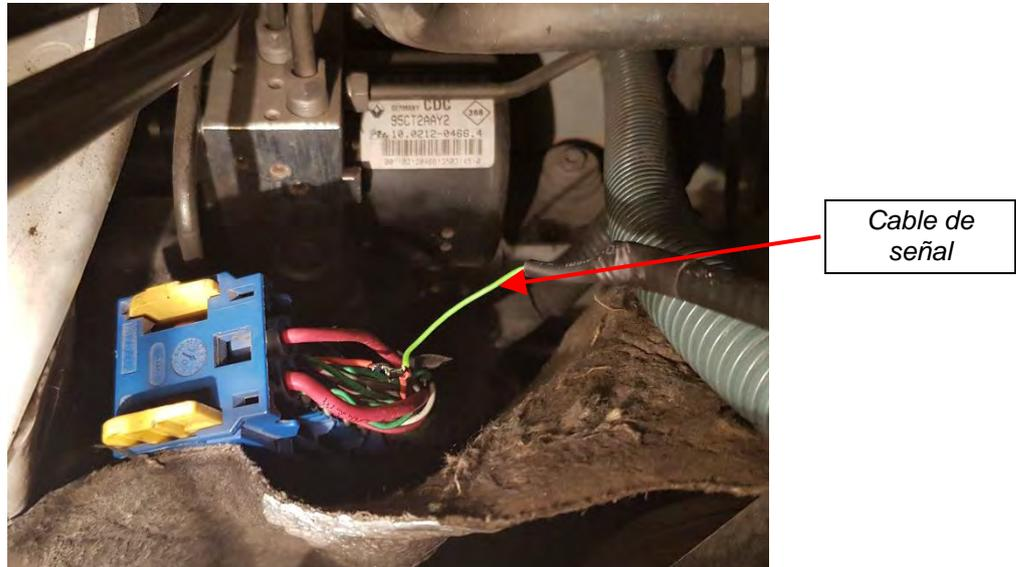
*Fig. 1.5. Detalle conexión cable señal al cable del pin nº 24 del conector 1094*
