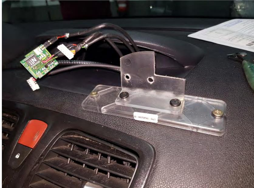
*Fig. 5.1. Instalación soporte para taxímetro*
