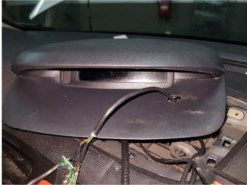
*Fig. 4.2. Salida de la manguera a la parte superior del habitáculo.*
