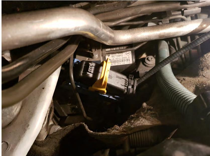
*Fig. 1.3. Detalle conector 1094 módulo ABS/ESP*
