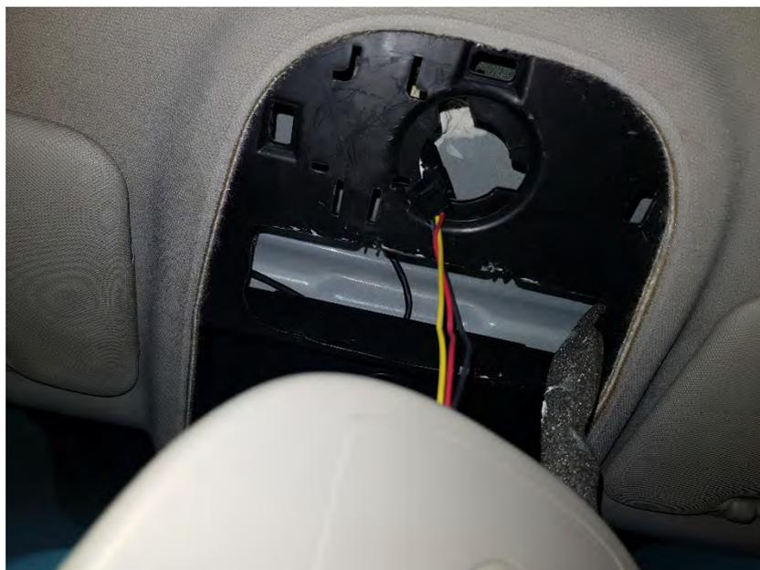
**Fig. 6.1** Desmontaje del plafón y taladrado de oficios para sujección del módulo y paso de cables
