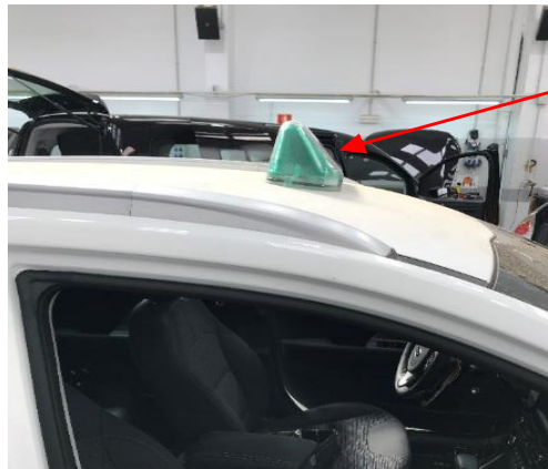
Fig. 6.1 Vista lateral del m3dulo atornillado
