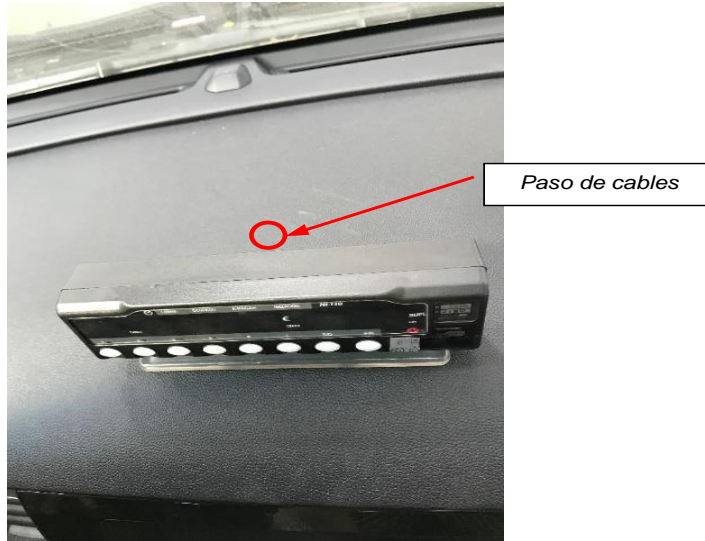
Fig. 4.5. Paso de cables para tax3metro de consola
