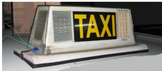
Fig. 6.3. Vista del módulo y su precinto
