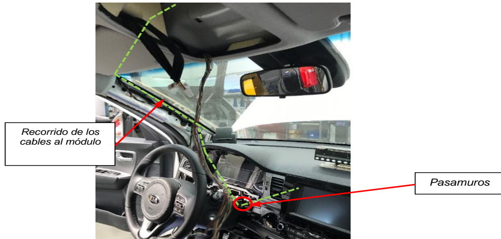
Fig. 6.2. Vista recorrido del cableado entre el módulo y la caja de conexiones
