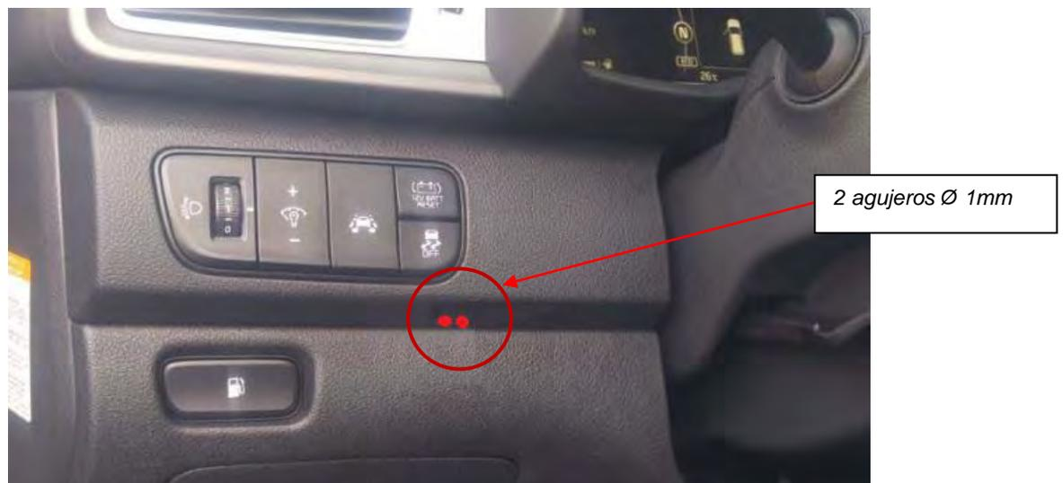
*Fig. 1.9. Perforado del salpicadero para paso del alambre.*
