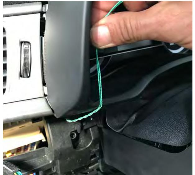
*Fig. 1.7 y 1.8. Vistas de la secuencia del precintado del cuadro de instrumentos.*
