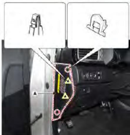
2. Desmonte el panel inferior del panel de protección (A) tras aflojar el tornillo.
