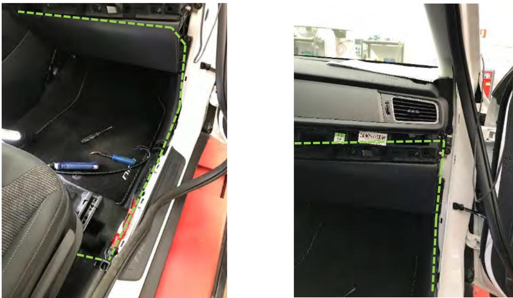
*Fig. 7.2 y 7.3. Recorrido de las conexiones desde el módulo de emergencias.*
