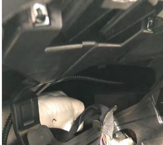
*Fig. 4.2. Paso de cables por dentro del salpicadero*
