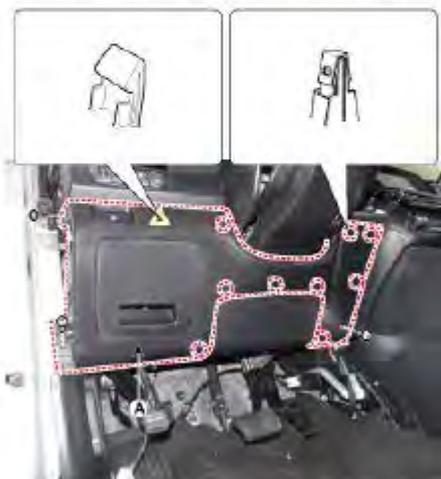
3. Desconecte el conector del interruptor de la compuerta de llenado de combustible (A).
