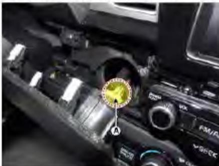
9. Desmonte el panel del tablero de instrumentos (A) con un extractor.
