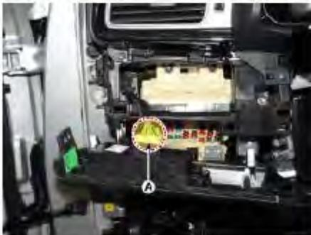
6. Desmonte la cubierta lateral del panel de protección [RH] (A) con un extractor.
