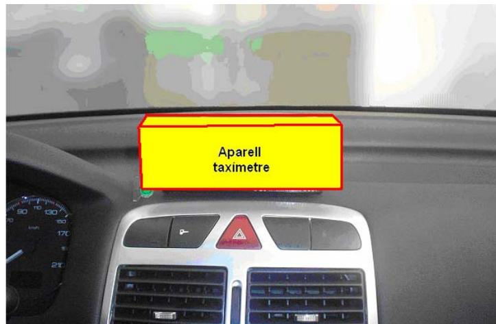
En el caso de que sea un aparato taxímetro dentro del espejo retrovisor interior del automóvil, todas las mangueras necesarias (alimentación, impulsos, módulo luminoso y dispositivo impresor) irán en el aparato taxímetro por el montante lateral del parabrisas del vehículo. Se ha de tener mucho cuidado para que estas mangueras no pasen nunca por la parte frontal del cojín de seguridad.
