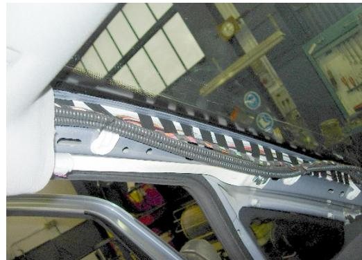
Una vez pasados los cables por el guarnecido del techo, se practicará un agujero que permitirá que puedan salir hacia el exterior del punto donde se realizará la conexión con el aparato taxímetro. Por este agujero pasarán todos los cables (de señal, de alimentación al aparato taxímetro, el del módulo repetidor de tarifas y, si procede, el de la terminal de comunicaciones).
