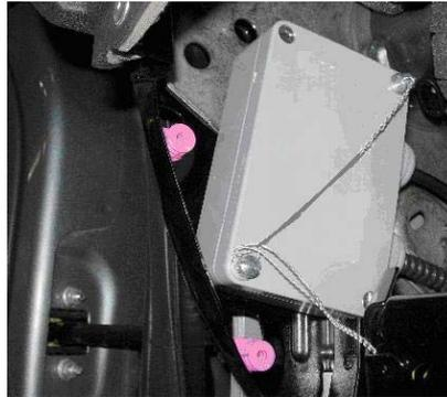
La manguera blindada de la caja adaptadora se llevará desde la caja adaptadora hasta la ubicación deseada del aparato taxímetro, por el pilar A izquierdo del parabrisas, hacia el habitáculo motor. De esta forma, las mangueras subirán hacia arriba por el pilar A, pasando por encima del guarnecido del techo.
