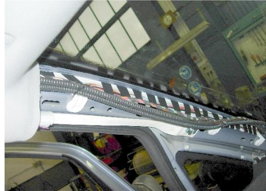
Una vez pasados los cables por el guarnecido del techo, se practicará un agujero que permitirá que puedan salir hacia el exterior del punto donde se realizará la conexión con el aparato taxímetro. Por este agujero pasaran todos los cables (de señal, de alimentación al aparato taxímetro, el del módulo repetidor de tarifas y, si procede, el de la terminal de comunicaciones).
