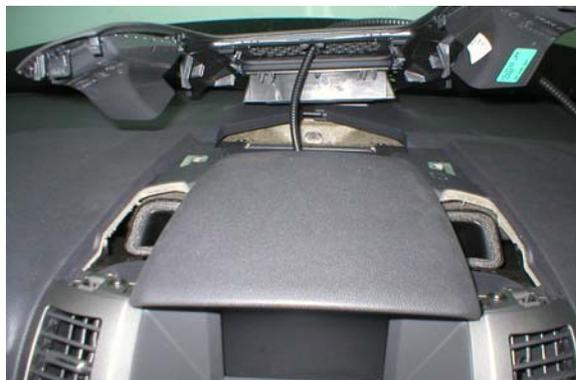
Se desmonta el equipo de radio y se hace pasar la manguera procedente de la caja adaptadora.
