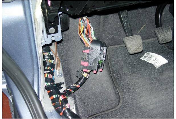
Una vez conectado al PIN 19 la señal de velocidad de la manguera blindada, se procede a colocar una caja precintable.
