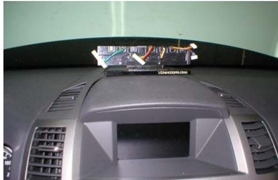
Se procede a la colocación de las mangueras correspondientes según el modelo del aparato taxímetro (manguera de señal, manguera de alimentación al aparato taxímetro, manguera hacia el módulo repetidor de tarifas y, si procede, manguera hacia el terminal de comunicaciones). Se conexionan las mangueras y se procede a su precintado.
