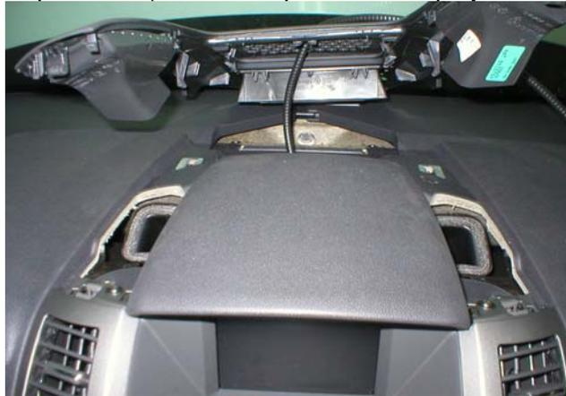
Se desmonta el equipo de radio y se hace pasar la manguera procedente de la caja adaptadora.
