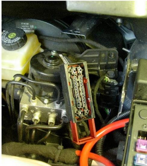
Se conecta nuevamente el conector a la unidad ABS y se procede a su cierre con alambre de precinto. Se vuelven a colocar el depósito del refrigerante encima de la unidad del ABS y la batería. Posteriormente, se procede a precintar el conector de la unidad del ABS, mediante un precinto del concesionario oficial OPEL que ha realizado la preinstalación.
