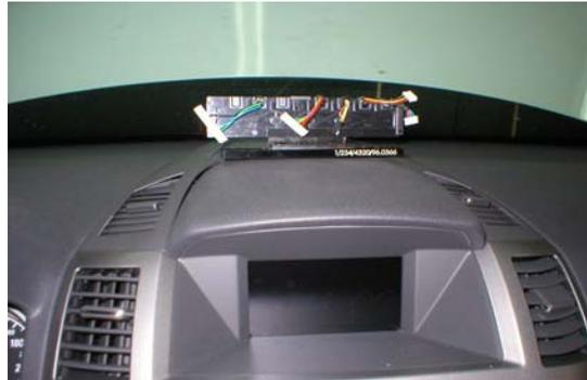
Se procede a la colocaci3n de las mangueras correspondientes seg3n el modelo del aparato taxímetro (manguera de señal, manguera de alimentaci3n al aparato taxímetro, manguera hacia el m3dulo repetidor de tarifas y, si procede, manguera hacia el terminal de comunicaciones). Se conexionan las mangueras y se procede a su precintado.
