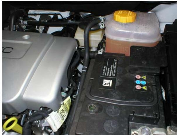
Se retira la batería del vehículo y se desmonta el depósito que está ubicado encima de la unidad del ABS.
