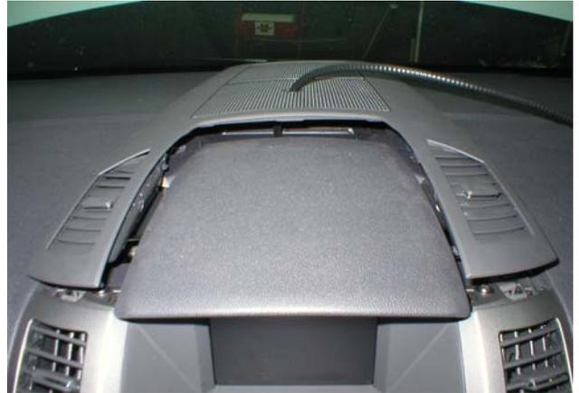
Se procede a instalar la caja adaptadora, fijada al salpicadero, en la parte posterior del aparato taxímetro.
