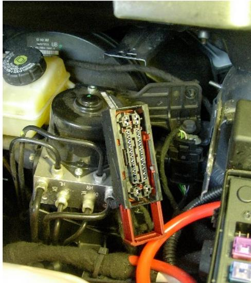
Se conecta nuevamente el conector a la unidad ABS y se procede a su cierre con alambre de precinto. Se vuelven a colocar el depósito del refrigerante encima de la unidad del ABS y la batería. Posteriormente, se procede a precintarlo con el conector de la unidad del ABS, mediante un precinto del concesionario oficial OPEL que ha realizado la preinstalación.
