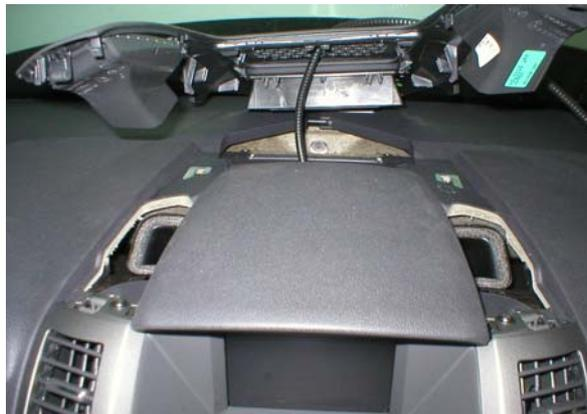
Se desmonta el equipo de radio y se hace pasar la manguera de señal.
