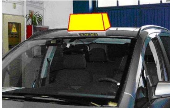
Si el módulo repetidor de tarifas se encuentra atornillado en el techo del vehículo, el cable de conexión irá por dentro del guarnecido interior del techo hasta el módulo, mediante manguera blindada. Si el módulo va instalado encima de una barra transversal, el paso del cable se hará por un agujero practicado en uno de los puntos de soldadura de los vierteaguas de los laterales del techo del vehículo (punto blanco).
