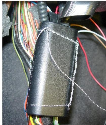
Posteriormente, se procede a precintar dicha caja precintable, mediante un precinto del concesionario oficial OPEL que ha realizado la preinstalación.
