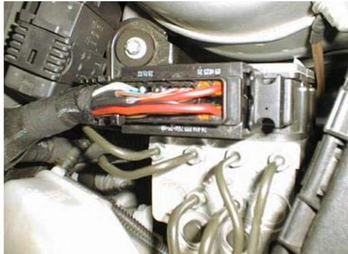
Se conecta el terminal del cable verde de la manguera blindada al conector PIN 18. Se comprueba que el alojamiento del PIN 18 dispone de terminal metálico.
