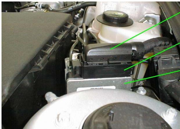
Conector hembra con salida del mazo de cables
