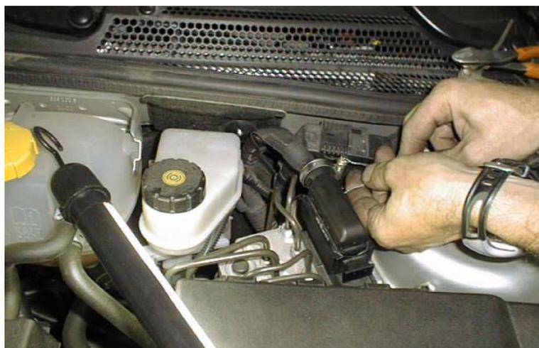
El alambre pasará primero por el agujero efectuado en la abrazadera metálica de sujeción; después por el alojamiento disponible en la parte posterior del conector; y posteriormente por el resto de los agujeros efectuados.
