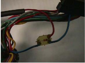
Se protege el componente con cinta aislante, montando el portaterminales con el conector y sujetando la instalación y la manguera blindada con dos bridas de plástico rápido.
