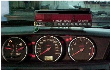
En la finalización de la instalación del aparato taxímetro se procederá al precintado de dicho instrumento metrológico.
