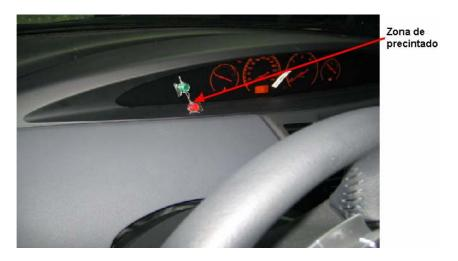
El precintado de la tapa del cuadro de instrumentos se realiza pasando primeramente el alambre de precintado por el soporte de una de las grapas de sujeció de esta tapa.
