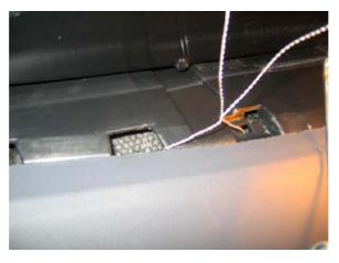
Se practican dos agujeros en la tapa del cuadro de instrumentos, que coincidan con la grapa que se une con el soporte de una de las grapas de sujeción de esta tapa que dispone del alambre de precintado. Se monta la tapa del cuadro de instrumentos, haciendo pasar el alambre de precintado por sus dos agujeros.
