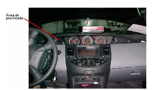
El precintado de la tapa se realiza con uno de los dos tornillos de sujeción de la tapa izquierda. Para realizar el precintado se substituye uno de los dos tornillos de anclaje de los extremos de la cuberta, por otra de tamaño y rosca similar pero con la cabeza taladrada.
