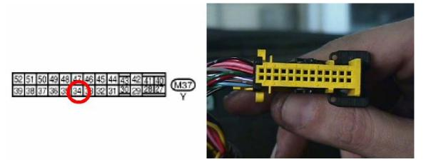
Se quita la tapa negra del lateral del conector amarillo, de forma que se puede separar el portaterminales del conector.
