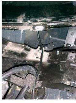
Se instalará la caja de conexiones en el amortiguador delantero derecho.
