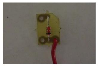
Se corta el cable azul/negro (L/B) indicado anteriormente y se intercala el diodo, comprovando el correcto estado de la soldadura y del componente.
