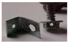
Se insertar en la base del tornillo una escuadra taladrada, para realizar el precintado como se muestra en la siguiente figura:
