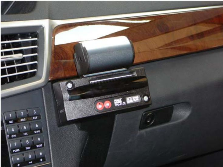
Para la instalación dentro de la guantera simplemente se conecta la impresora a las conexiones CAN y de alimentación que allí se encuentran.
