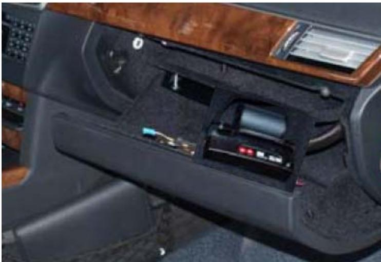
Para la instalación en el reposabrazos que queda entre los dos asientos delanteros se hará con el soporte que trae el kit de la impresora. Las conexiones CAN y de alimentación se localizan debajo del compartimento portaobjetos de la consola central, que se deberán hacer llegar hasta el interior del reposabrazos.
