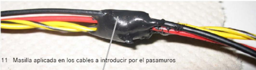
Figura 11 Masilla aplicada en los cables a introducir por el pasamuros
