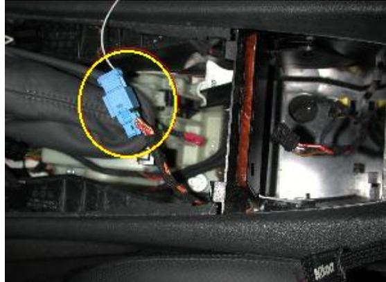
Se vuelve a montar la caja del guardaobjetos y el revestimiento situado dentro de la guantera del repolsabrazos central. Encima se instala el dispositivo impresor, sujeto mediante un sistema de "velcro" encima del repolsabrazos central.
