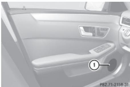
El altavoz de radiocomunicación ① montado en el panel de la puerta izquierda es un altavoz de doble bobina para el funcionamiento del equipo de radiocomunicación y de la radio.
