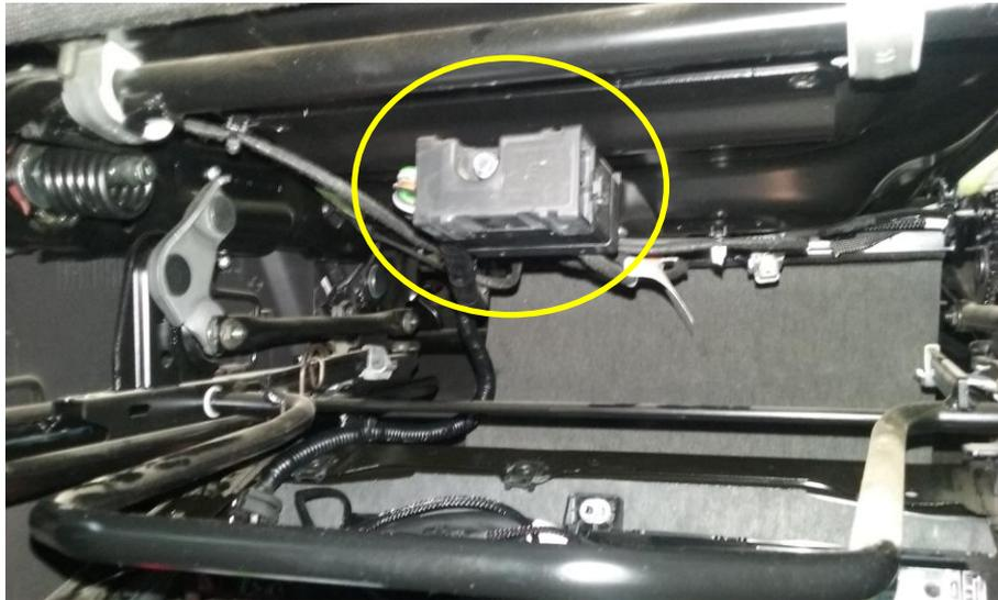
Desmontada también después la tapa del alojamiento de las baterías sugerimos la desconexión de una de ellas y que se extraiga al igual que el vaso que las aloja para tener un acceso más cómodo al Conector del Interfaz
