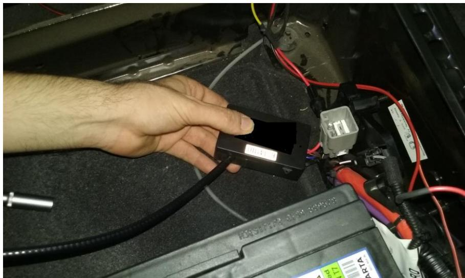
A continuación llevamos a cabo la colocación del alambre corrugado – que posteriormente se precintará - que rodee la caja e impida que ésta se abra.
