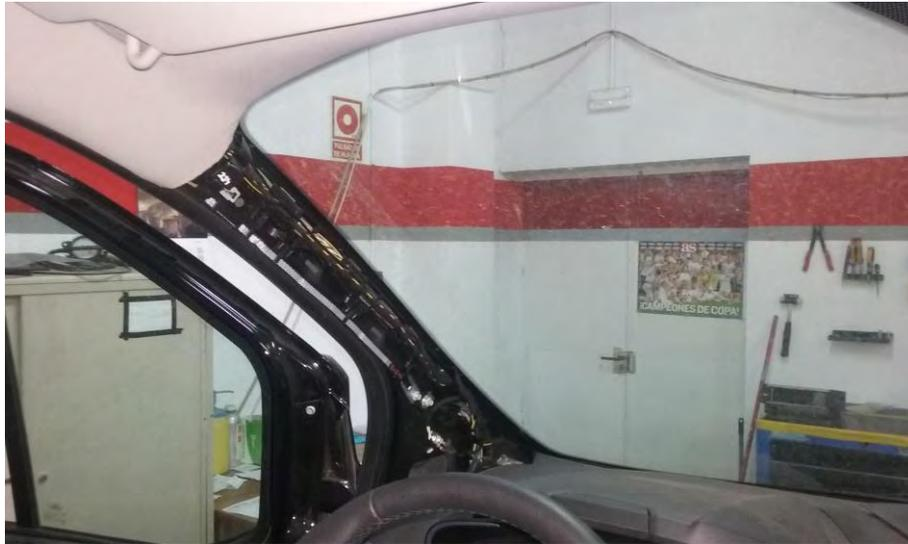
Volvemos a recurrir a la guía para el paso del cableado a la zona izquierda de la columna de dirección. Dicha zona es accesible quitando su guarnecido inferior el cual está fijado mediante grapas.
