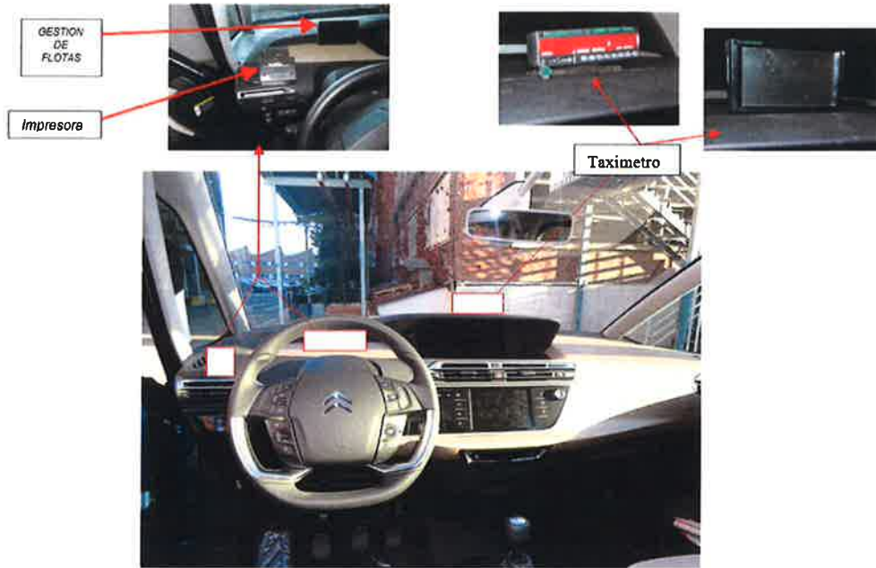
Fig. 8.1 Vistas de la disposición del taxímetro, impresora y gestión de flotas.
