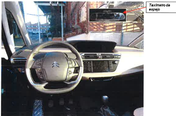
Fig. 10.1. Vistas de la disposición del taxímetro de espejo
