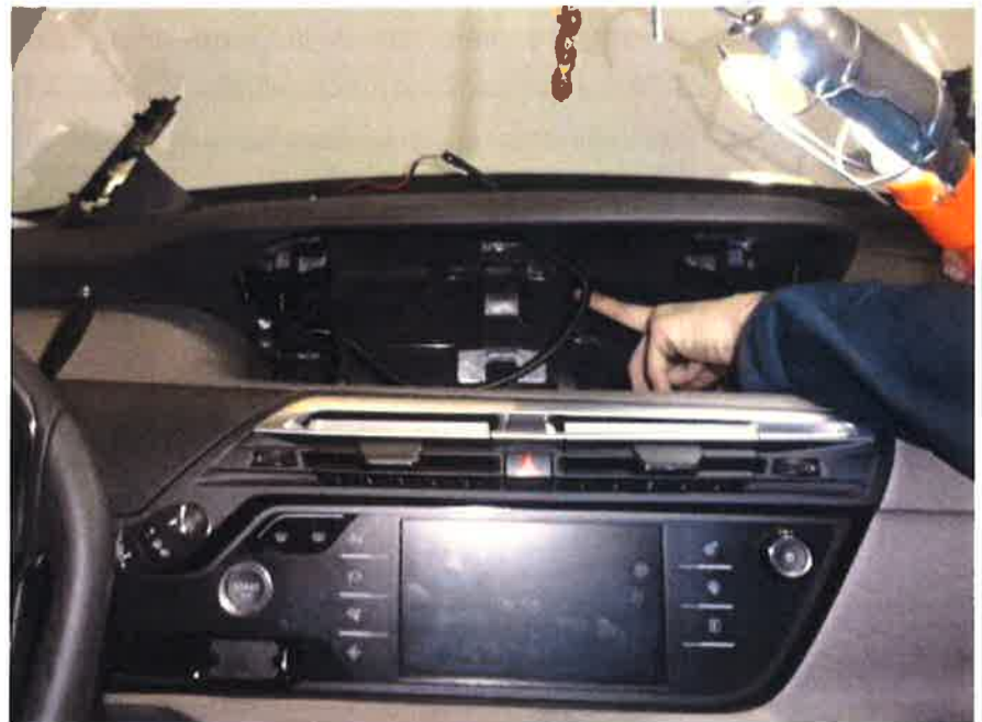
Fig. 3.1. Fotografía del cable coarrugado llevado hasta la consola central.
