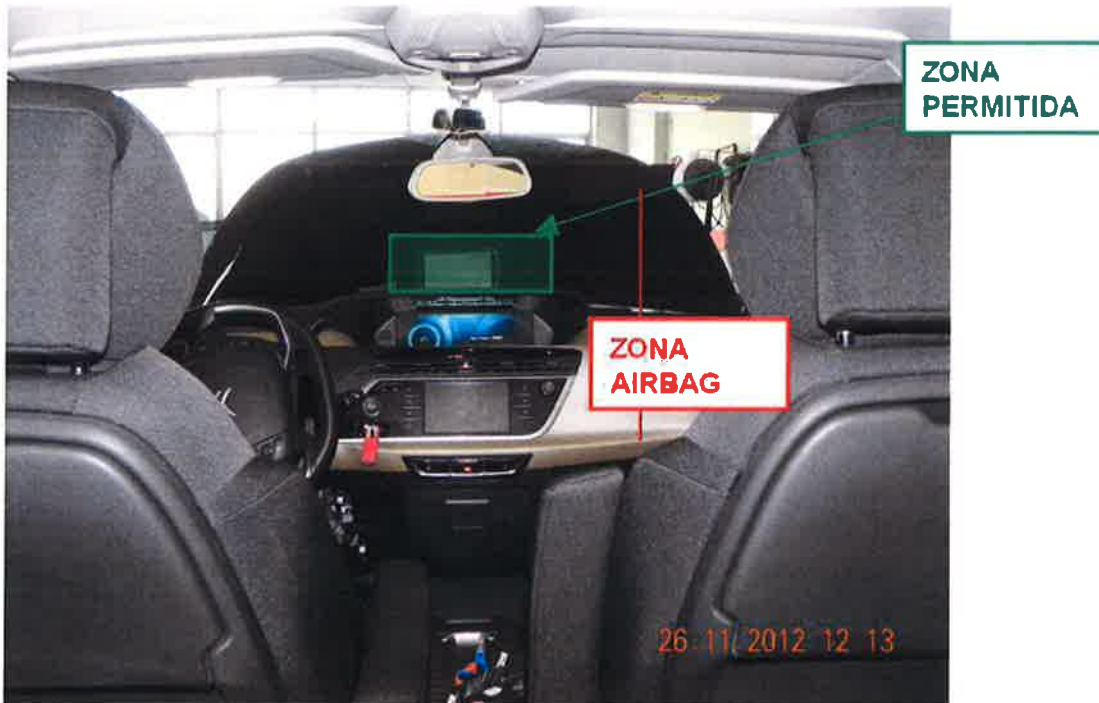
Fig. 6.1. Vista de la zona permitida para la instalación del taxímetro.
