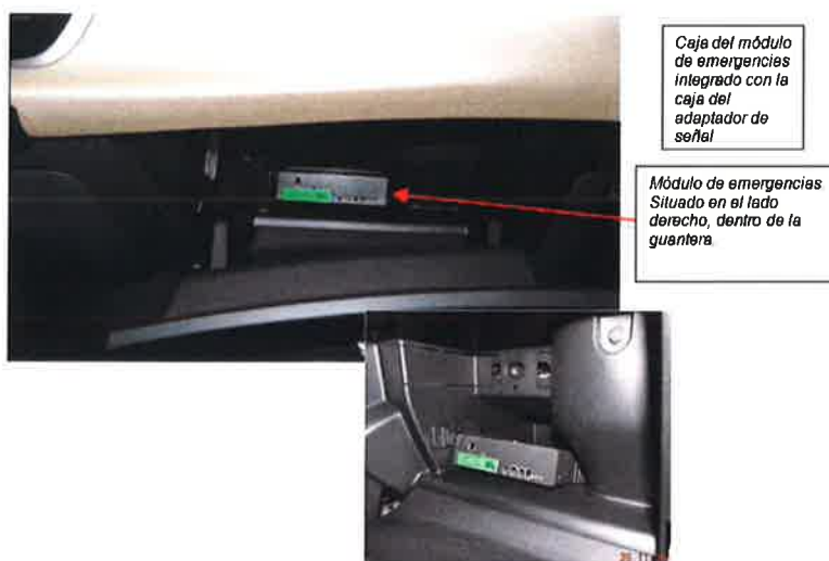
Fig. 12.1.1 Vista del emplazamiento del módulo de emergencias en la parte inferior delantera de la consola central.
