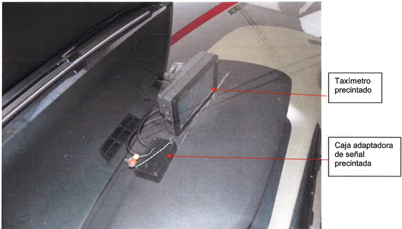
Fig. 2.1. Vista del taxímetro con la caja conversor-adaptador.
