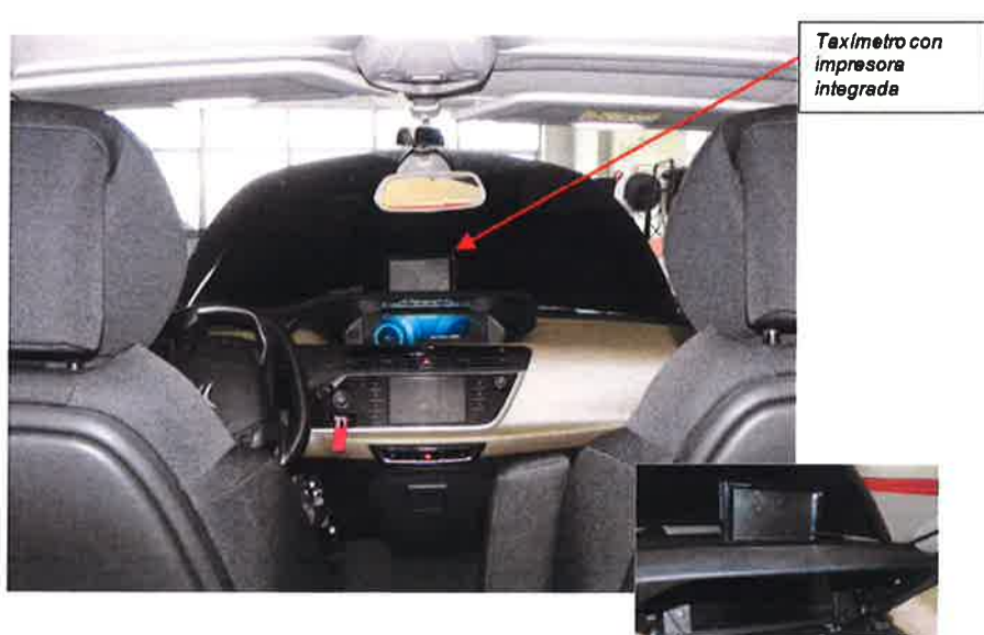
Fig. 9.1 Vistas de la disposición del taxímetro con impresora integrada.
