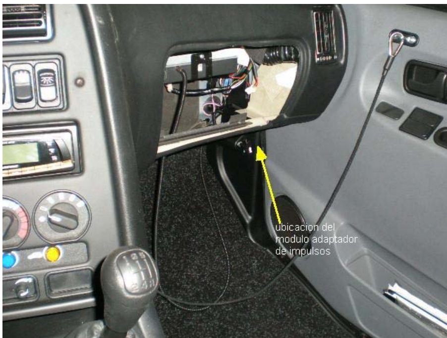
El modulo adaptador de impulsos se aloja en el pilar A del lado derecho por encima del tirador de apertura del capo y por debajo del salpicadero.
