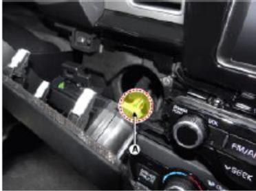
4. Desmonte el panel del tablero central (A) con un extractor.
