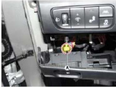
4. Desmonte la placa del panel de protección [LH] (A) tras aflojar el tornillo.
