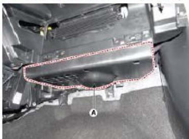
8. Desmonte la carcasa de la guantera (A) tras aflojar los tornillos, los pernos y las tuercas de montaje.
