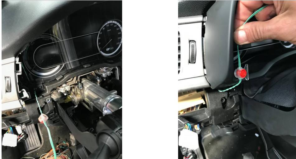
**Fig. 1.6 y 1.7.** Vistas del precintado del cuadro de instrumentos.
