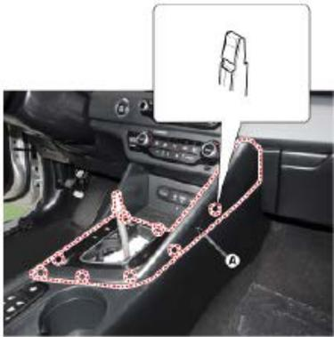
9. Desconecte el conector de la cubierta superior de la consola (A).
