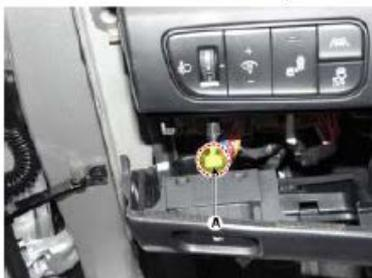
4. Desmonte la cubierta lateral del panel de protección [RH] (A) con un extractor.
