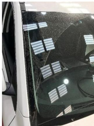
**Fig. 6.5.** Recorrido del cable del módulo por el exterior del marco del prabrisas
