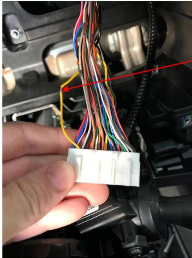
Cable del PIN18 del conector M05
