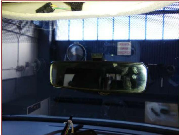
Desmontamos el embellecedor del montante izquierdo para llevar la instalación del espejo.
