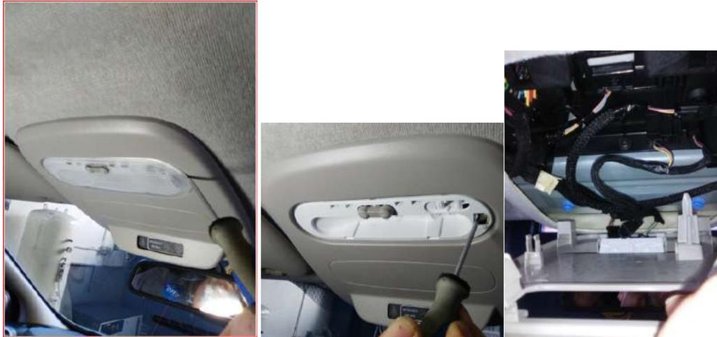
Una vez suelto ya tenemos acceso para pasar los cables del taxímetro de espejo que colocaremos en lugar del espejo de origen
