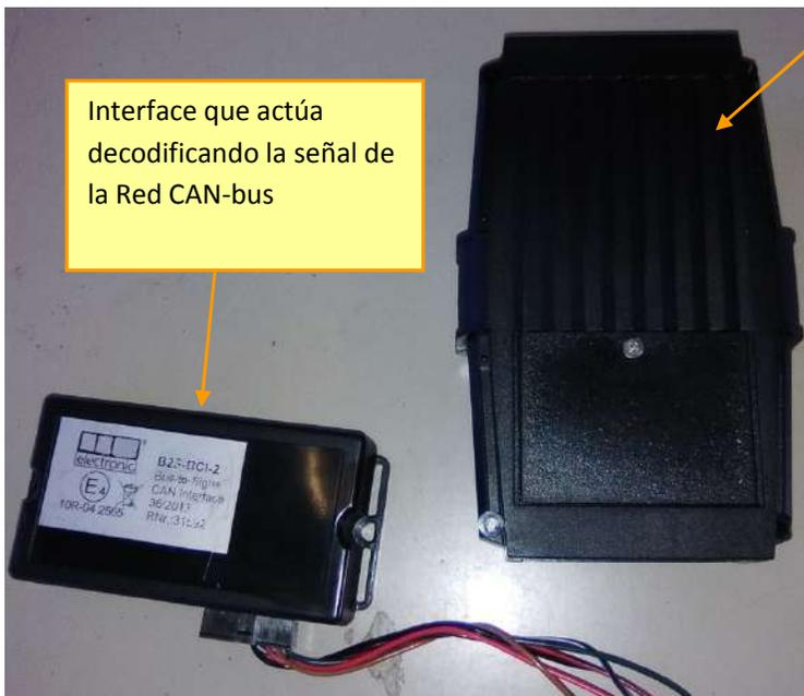
Interface que actúa decodificando la señal de la Red CAN-bus
