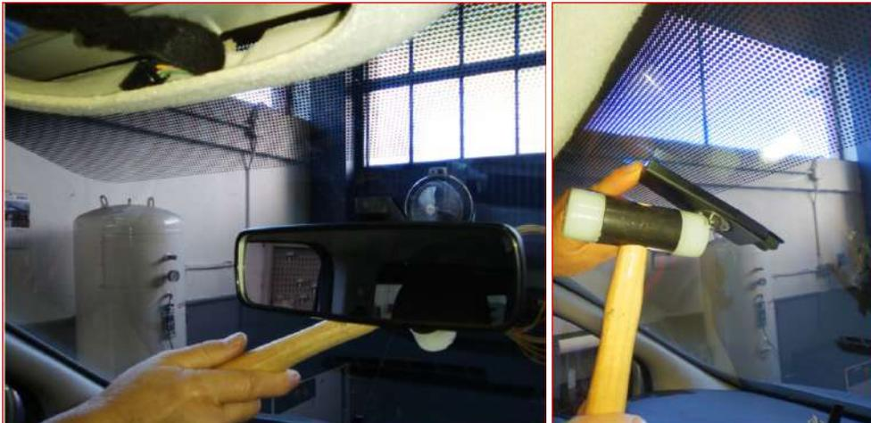
Una vez acoplado subimos la instalación por el techo y la conducimos por el hueco del plafón al igual que la instalación del módulo tarifario.
