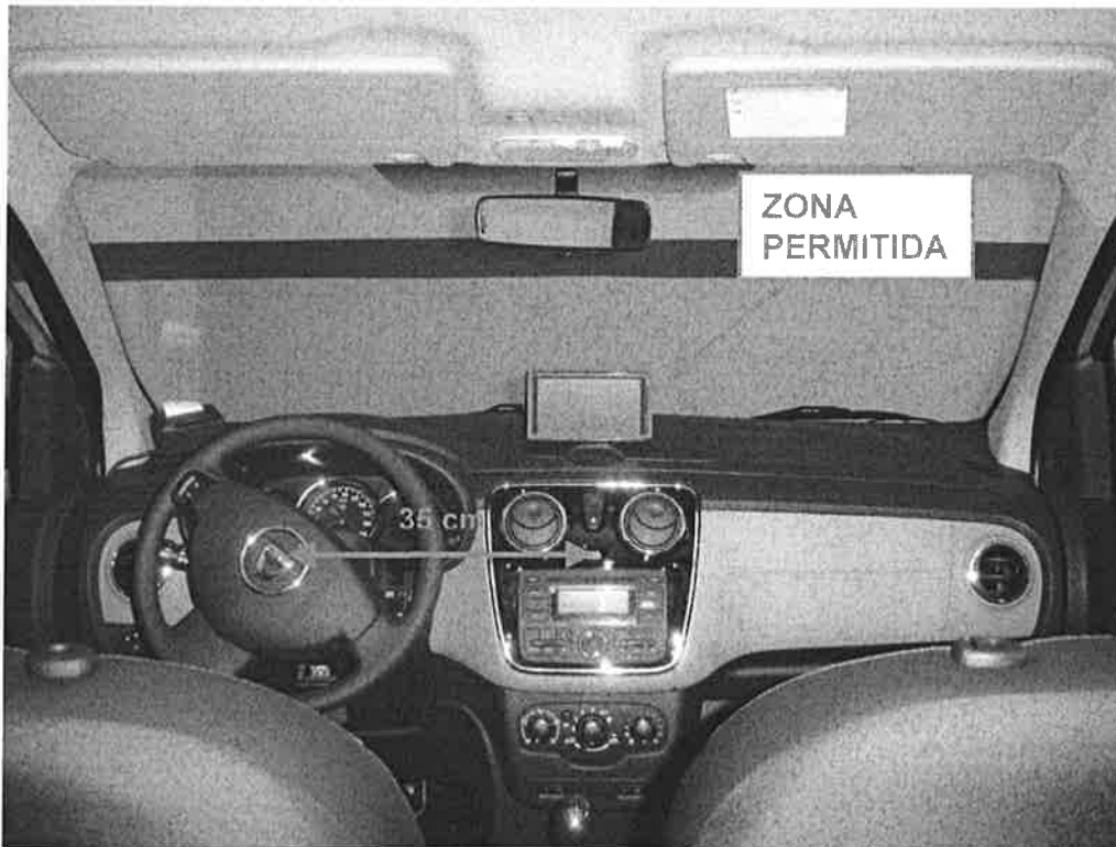
Fig. 5.1. Vista de la zona permitida para la instalación del taxímetro.
