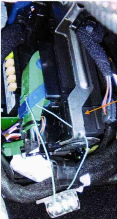
Detalle del bastidor metálico por donde se pasa el cable de precintado
