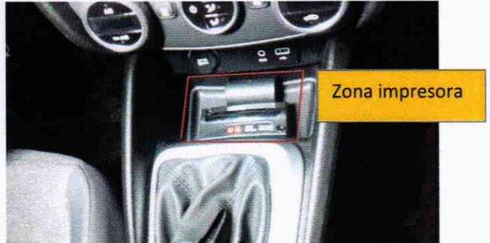
En la figura de la izquierda fijamos la impresora en la zona izquierda del salpicadero bien con soporte o a través de cinta de doble cara.
