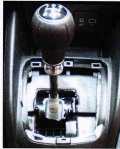
Desmontamos los guardapolvos de palanca de cambios y de freno de mano
