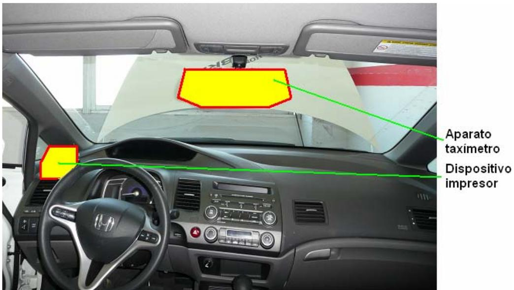
El módulo luminoso repetidor de tarifas se instalará en el techo del vehículo, de acuerdo con las instrucciones del fabricante del módulo luminoso. Se hará pasar el cable hasta el interior del compartimento motor a través del marco lateral de parabrisas delantero. El cable pasará por el montante lateral frontal derecho. Se ha de tener mucho cuidado para que estas mangueras no pasen nunca por la parte frontal del airbag.
