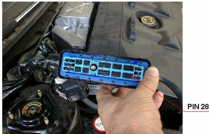
Para estos tipos de motorizaciones, la señal se toma directamente desde el pin 28, mediante un cable que entra a una caja precintable y que sale de la caja, protegido por una manguera blindada. Esta caja precintable deberá de estar fijada al propio módulo PCM.
