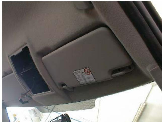
La toma de alimentación es conducida, mediante manguera blindada, desde la batería hasta una caja precintada, donde se encuentra el fusible de protección eléctrica. Posteriormente, la manguera blindada de alimentación se hará subir por el pilar A derecho hacia el techo, para salir al habitáculo de las gafas, donde estará ubicado el aparato taxímetro.
