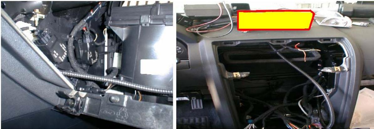
La toma de alimentación es conducida, mediante manguera blindada, desde la batería hasta una caja precintada, donde se encuentra el fusible de protección eléctrica. Posteriormente, la manguera blindada de alimentación se hará pasar por detrás del salpicadero, con el objeto de hacerlo salir por la parte superior central de salpicadero, donde se realizará un agujero para hacerlo salir. Posteriormente se efectúa la conexión en el aparato taxímetro.
