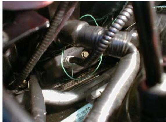
La entidad reparadora-instaladora de aparatos taxímetros se encontrará en la guantera del vehículo de servicio de autotaxi la manguera blindada con la señal de velocidad, con el objeto de efectuar la instalación definitiva del aparato taxímetro.
