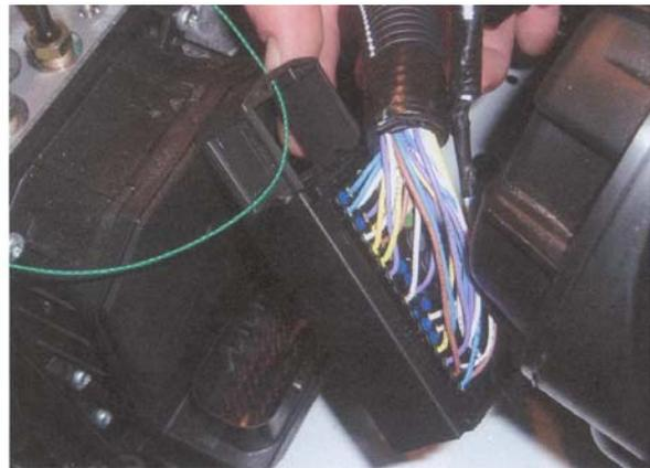
Para finalizar el precintado, se utilizará la abrazadera metálica para sujetar las mangueras blindadas que salen del módulo ABS, haciendo un agujero por el tornillo de dicha abrazadera. Una vez pasado el alambre del precinto por los tres agujeros de la tapa de conexiones, se pasará también por el agujero del tornillo de la abrazadera metálica. Finalmente, se pone el precinto con el objeto de impedir el acceso al módulo de ABS.
