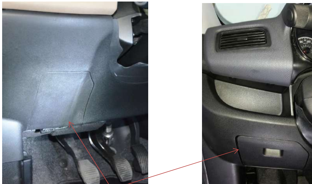
Desmontar tapa de fusibles
