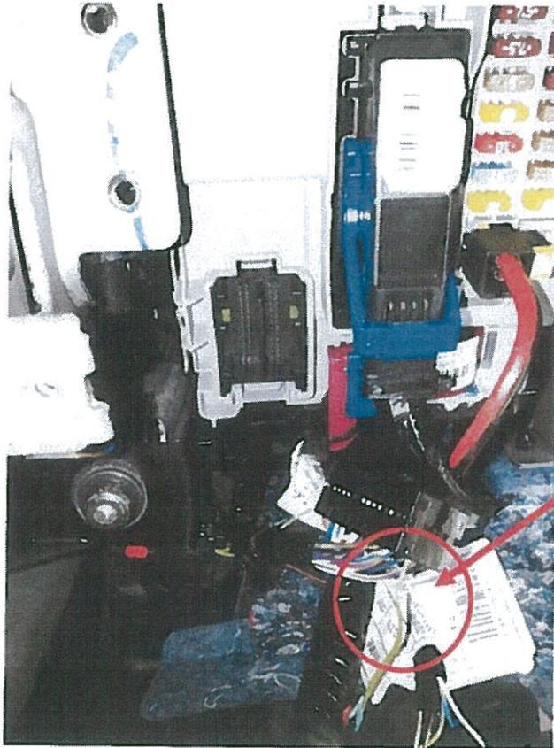
Conectar cable dentro de funda blindada a Conector (B) M001 en pin 19.
