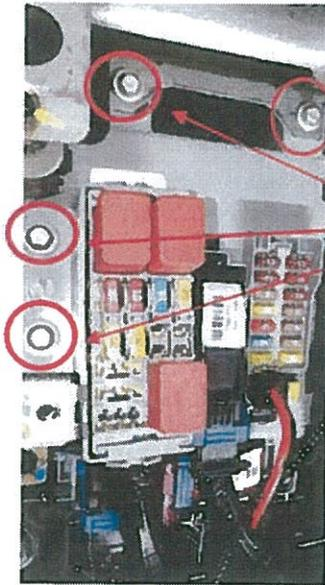
Quitar los tornillos de fijación la centralita de fusibles auxiliar
